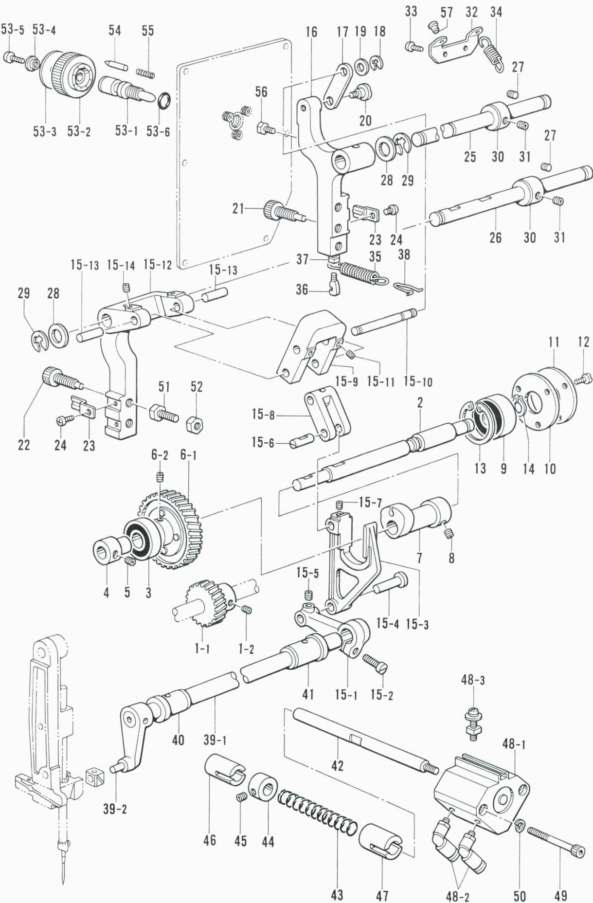
C. 針振関係/Zigzag mechanism/Zickzackvorrichtung/
