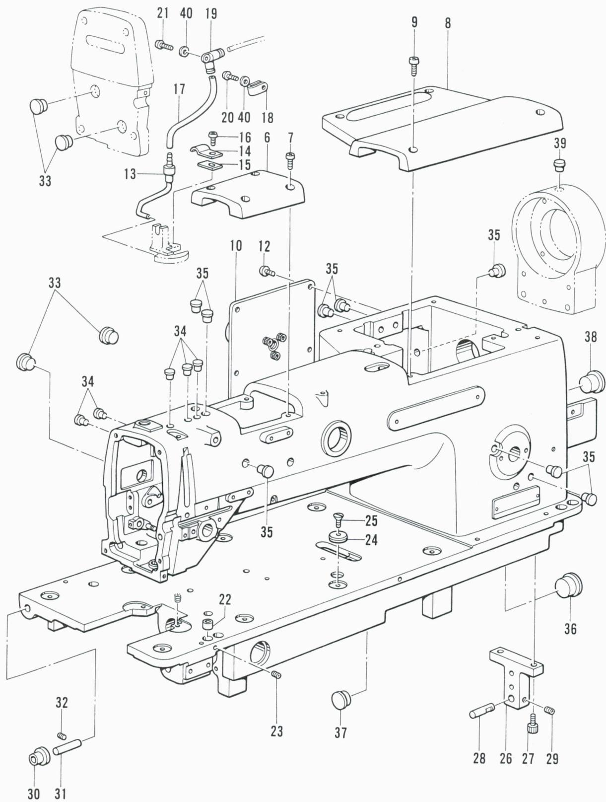
A. 主体関係/Machine body/Maschinengehäuse/
