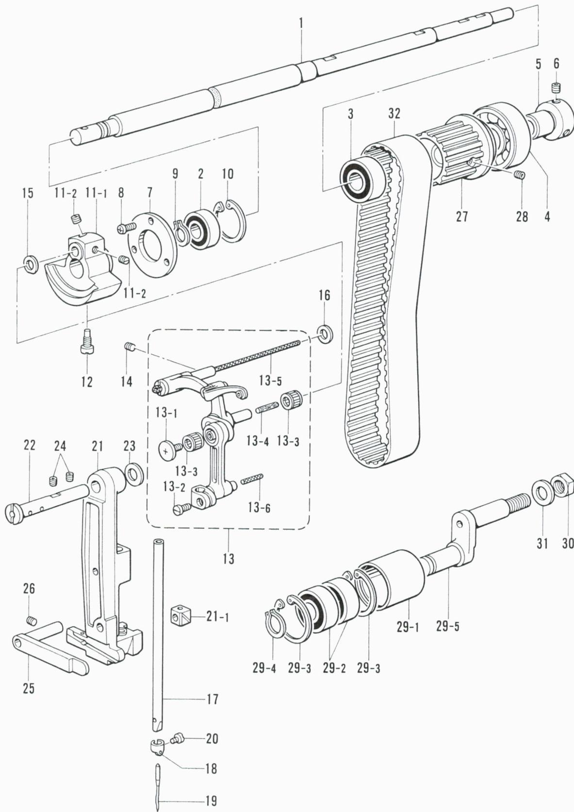
B. 針棒・天秤関係 / Needle bar and thread take-up mechanism / Nadelstange und Fadenabnahmeverrichtung /
