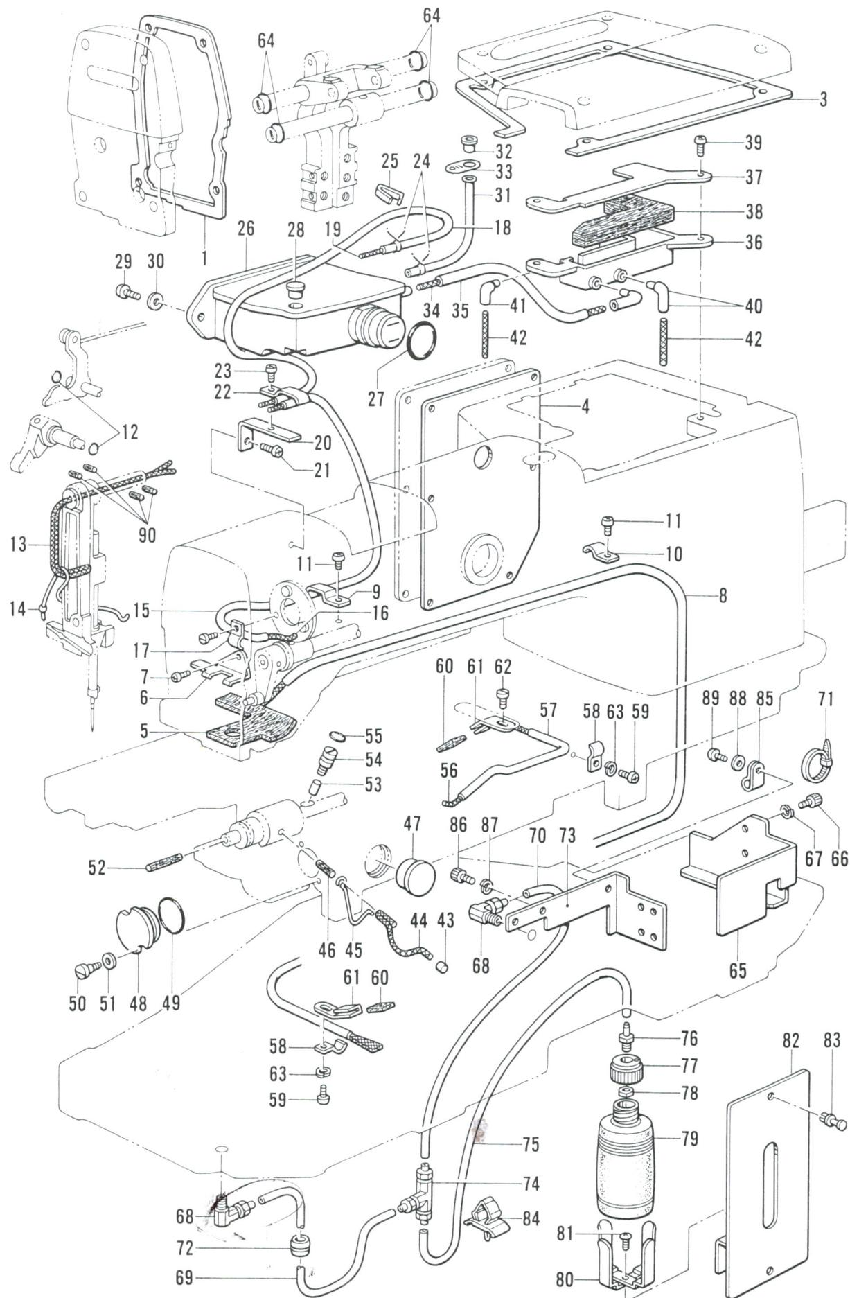
M. カマ関係 / Rotary hook mechanism / Greifervorrichtung /
