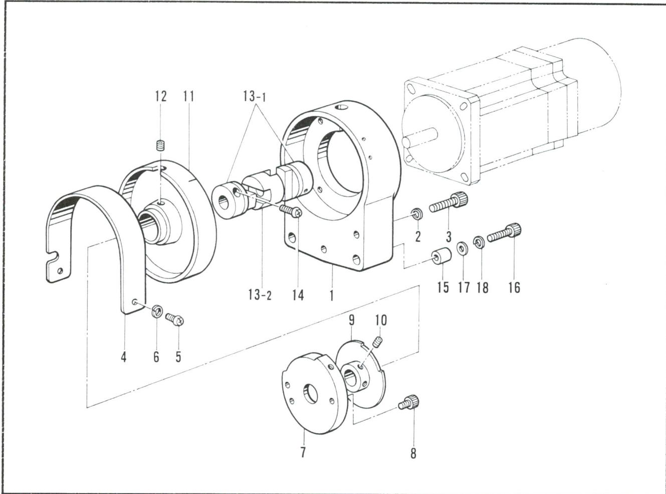
Y. 踏板関係/Foot switch pedal mechanism/Fußbetätigungs/
