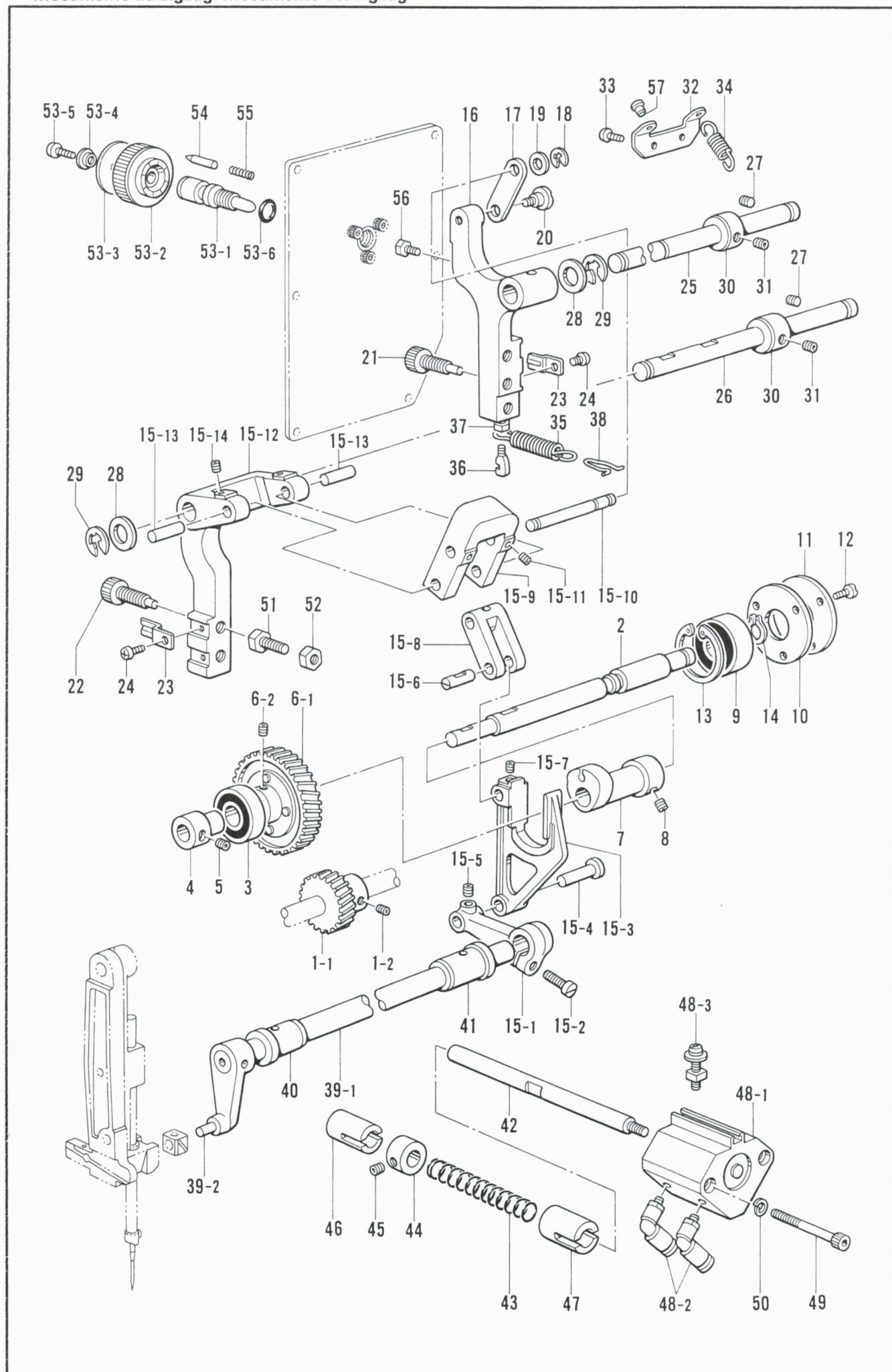
C. 針振関係/Zigzag mechanism/Zickzackvorrichtung/
