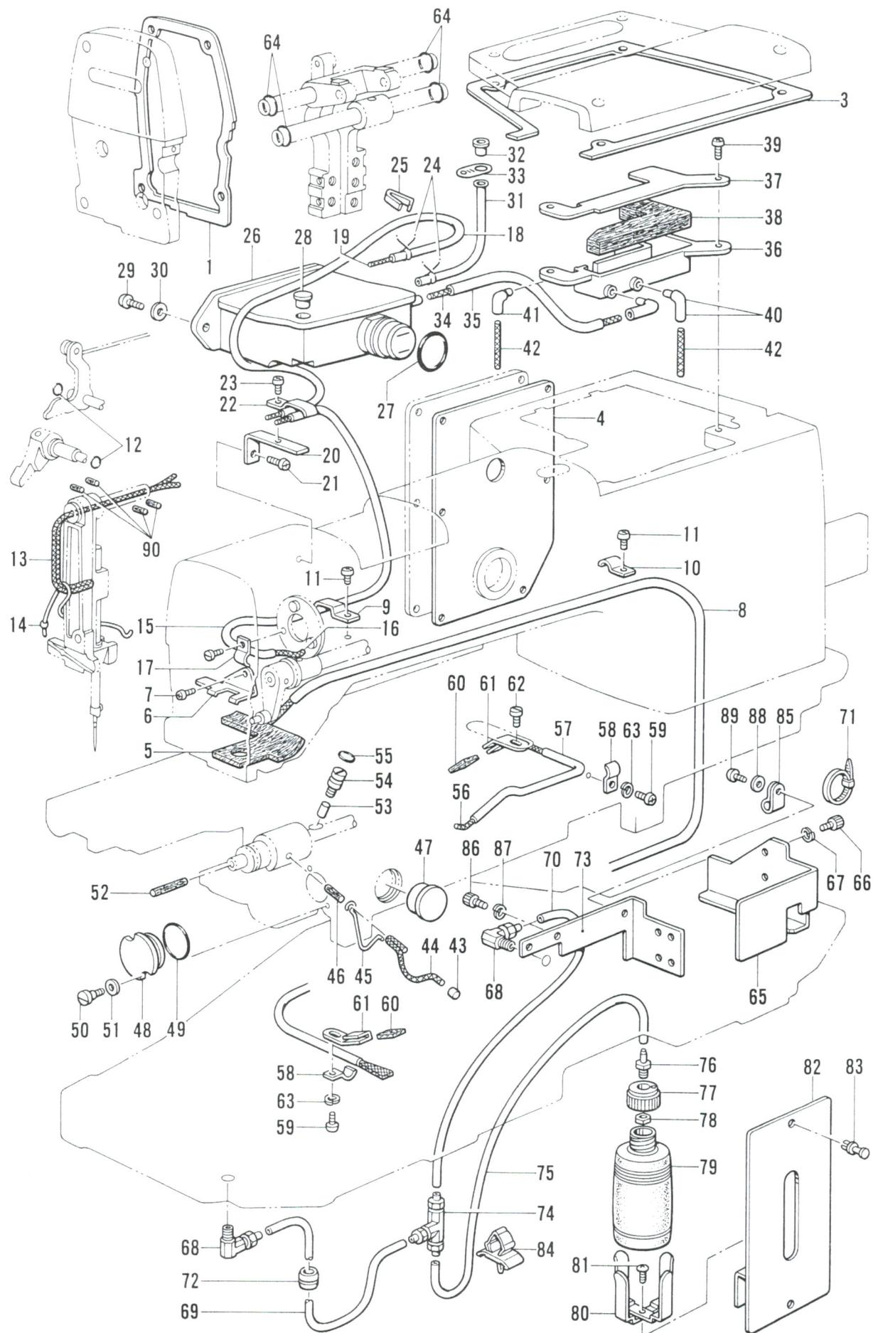
N. 給油・潤滑関係/Lubrication/Schmierung/
