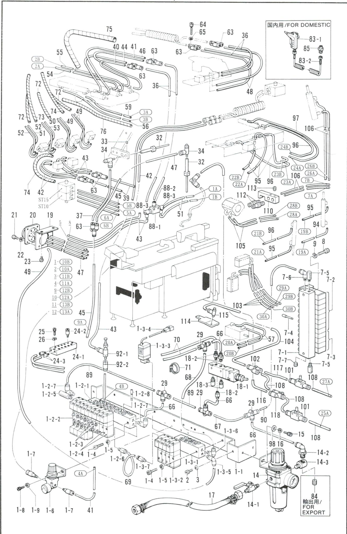
R. 糸切り関係/Thread trimmer mechanism/Fadenabschneidevorrichtung/
