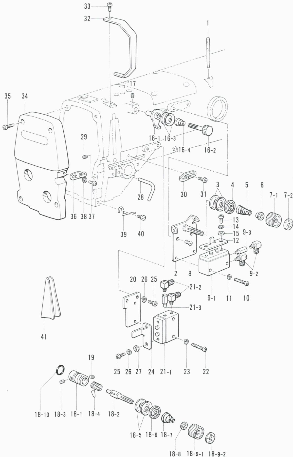
N. 給油・潤滑関係 / Lubrication/Schmierung/
