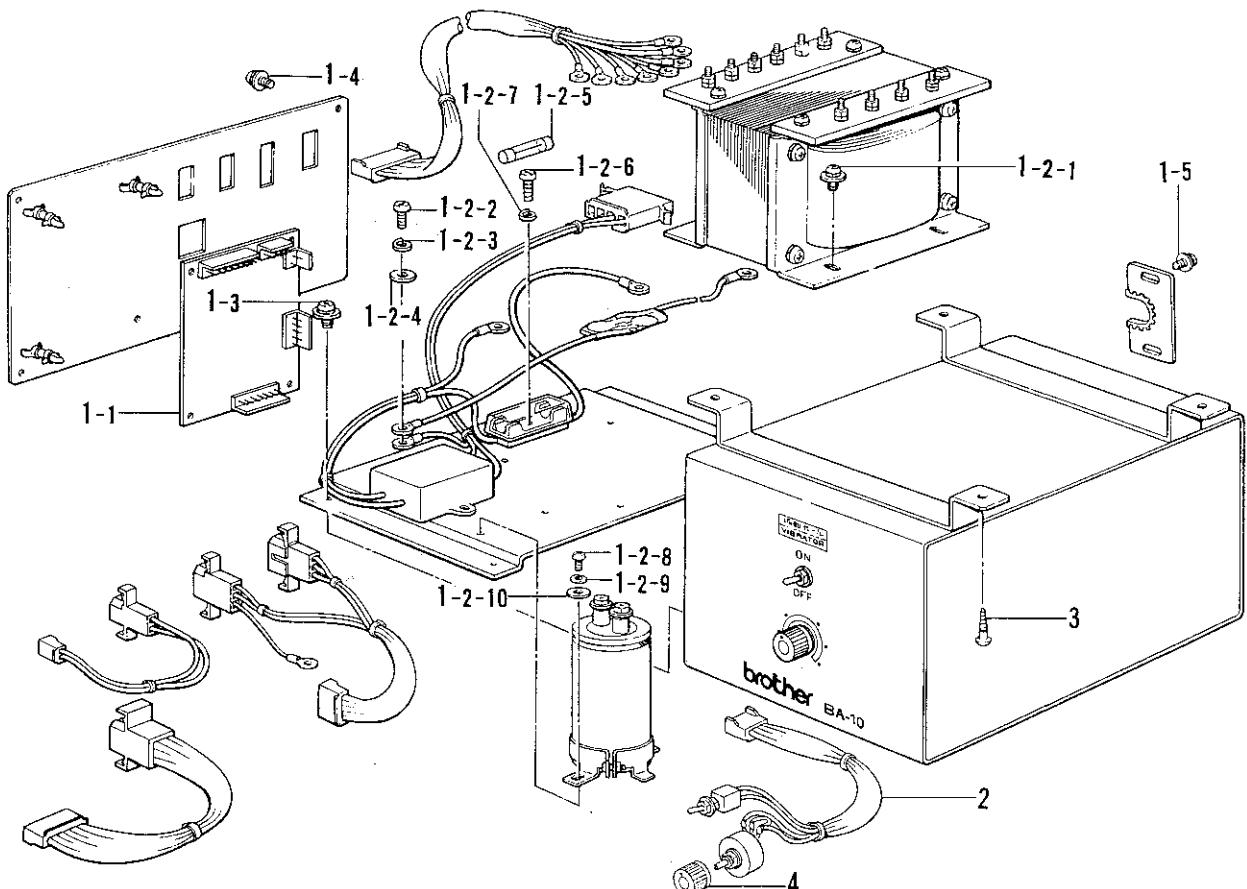
S. ボタン検知関係/Button detector mechanism/Knopfdetektor/Détecteur de bouton/Detector de botones
