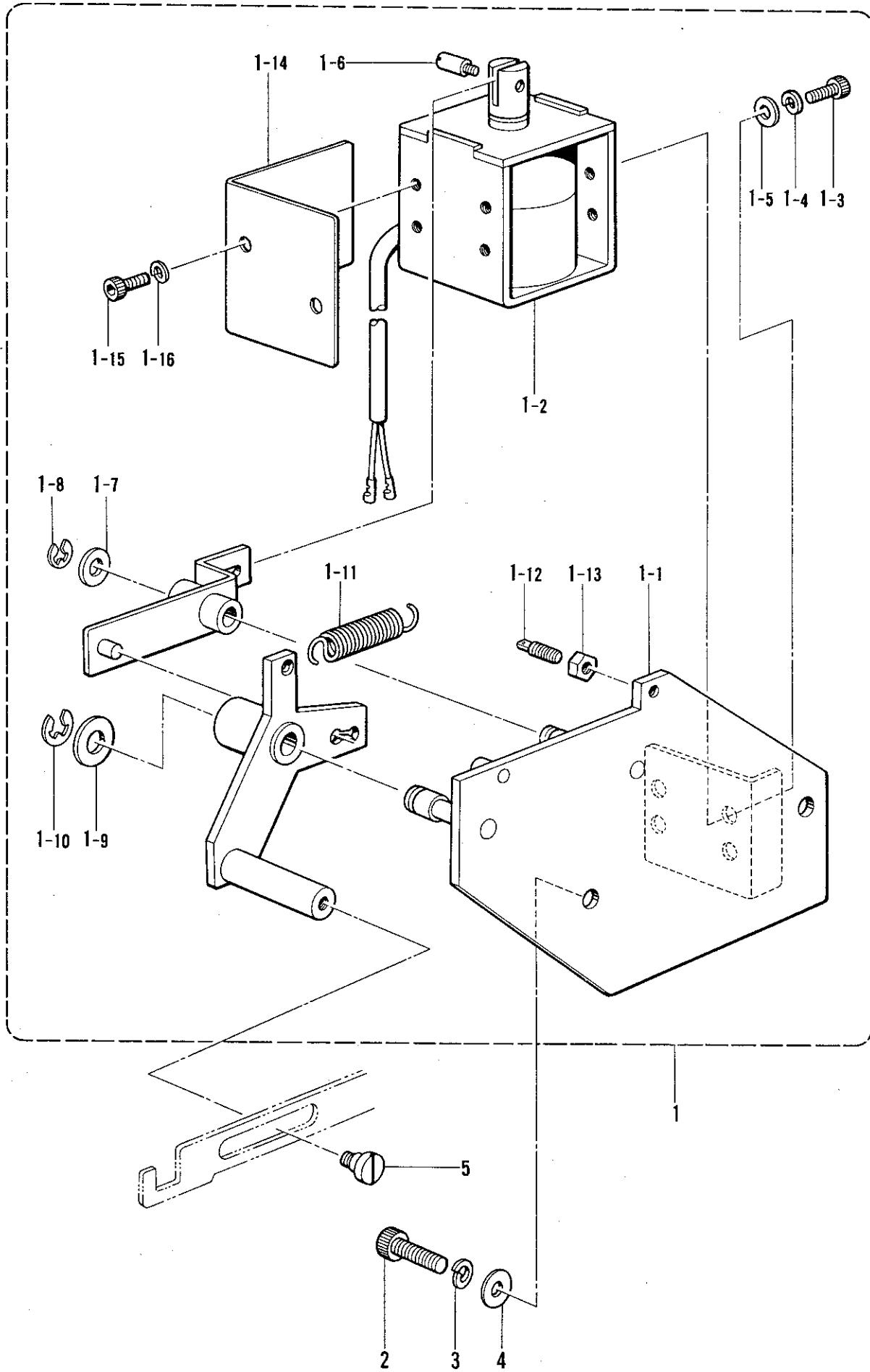
M. 渡り糸関係/Crossover stitch mechanism/Verbindungsstichvorrichtung/
