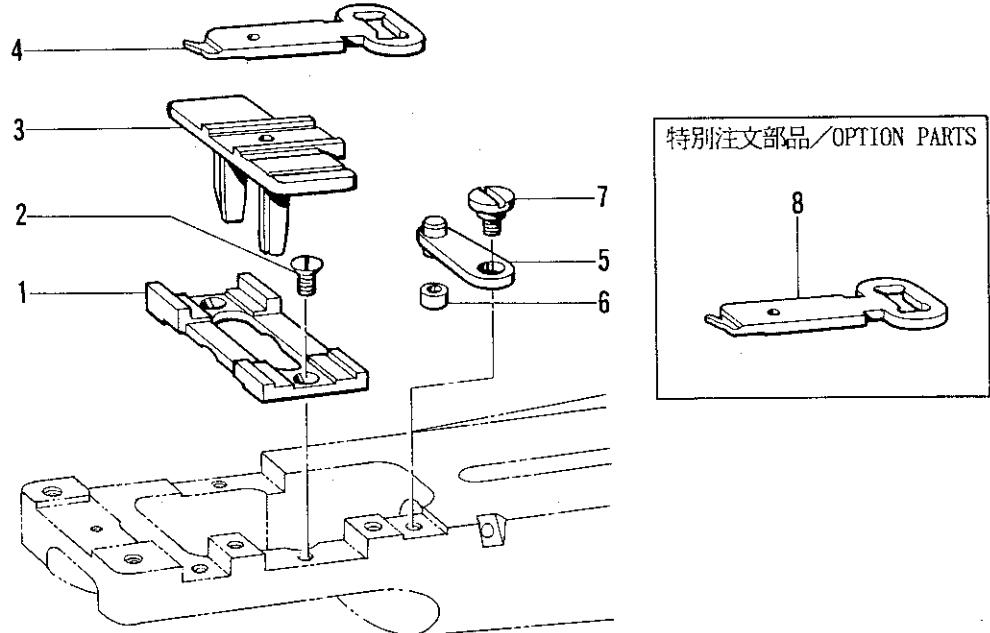
L. 糸拭き関係/Tread wiper mechanism/Fadenwischvorrichtung/
