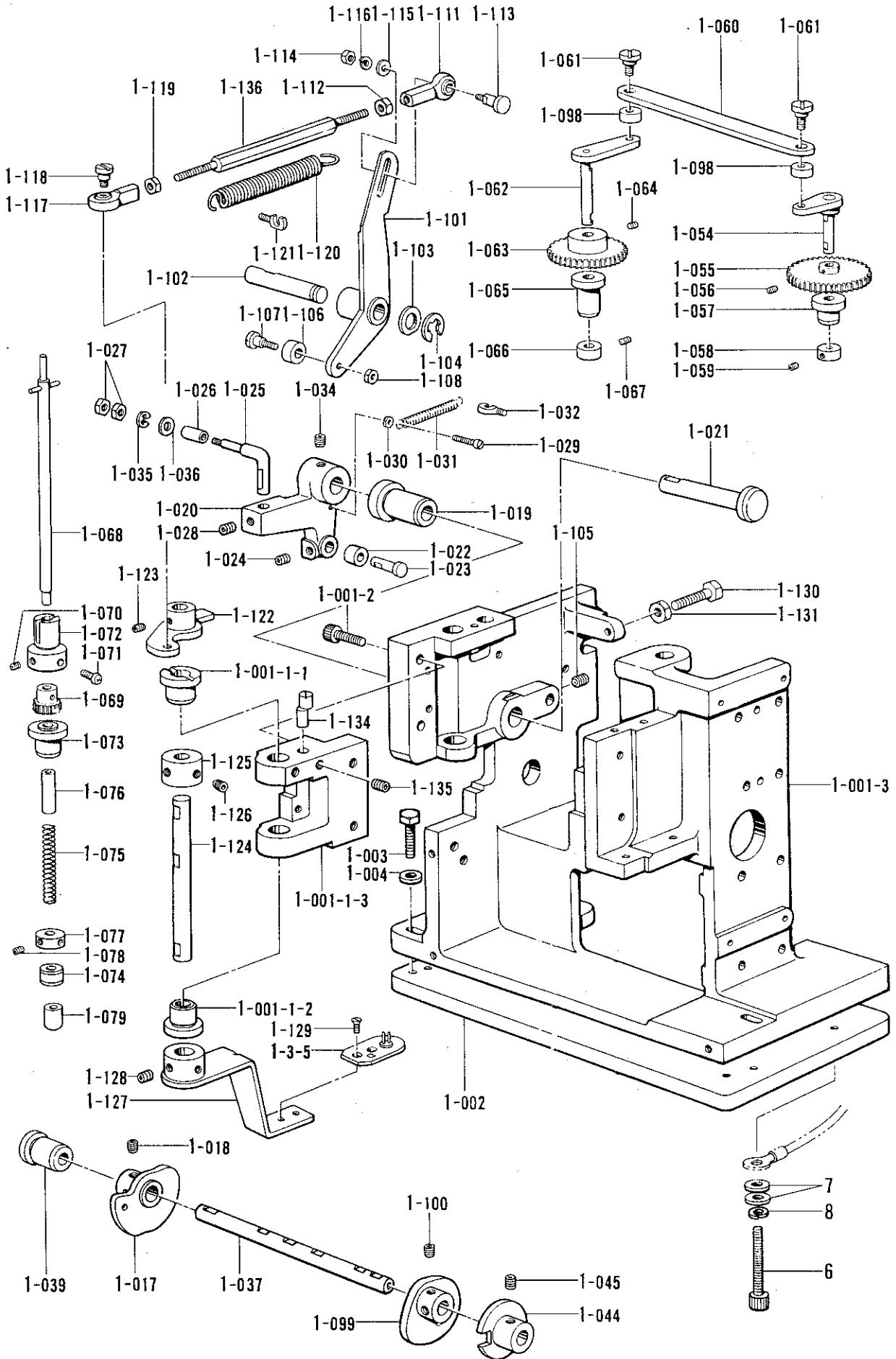
P1. ボタンフィーダー関係/Button feeder mechanism/Knopfzuführungsvorrichtung/
