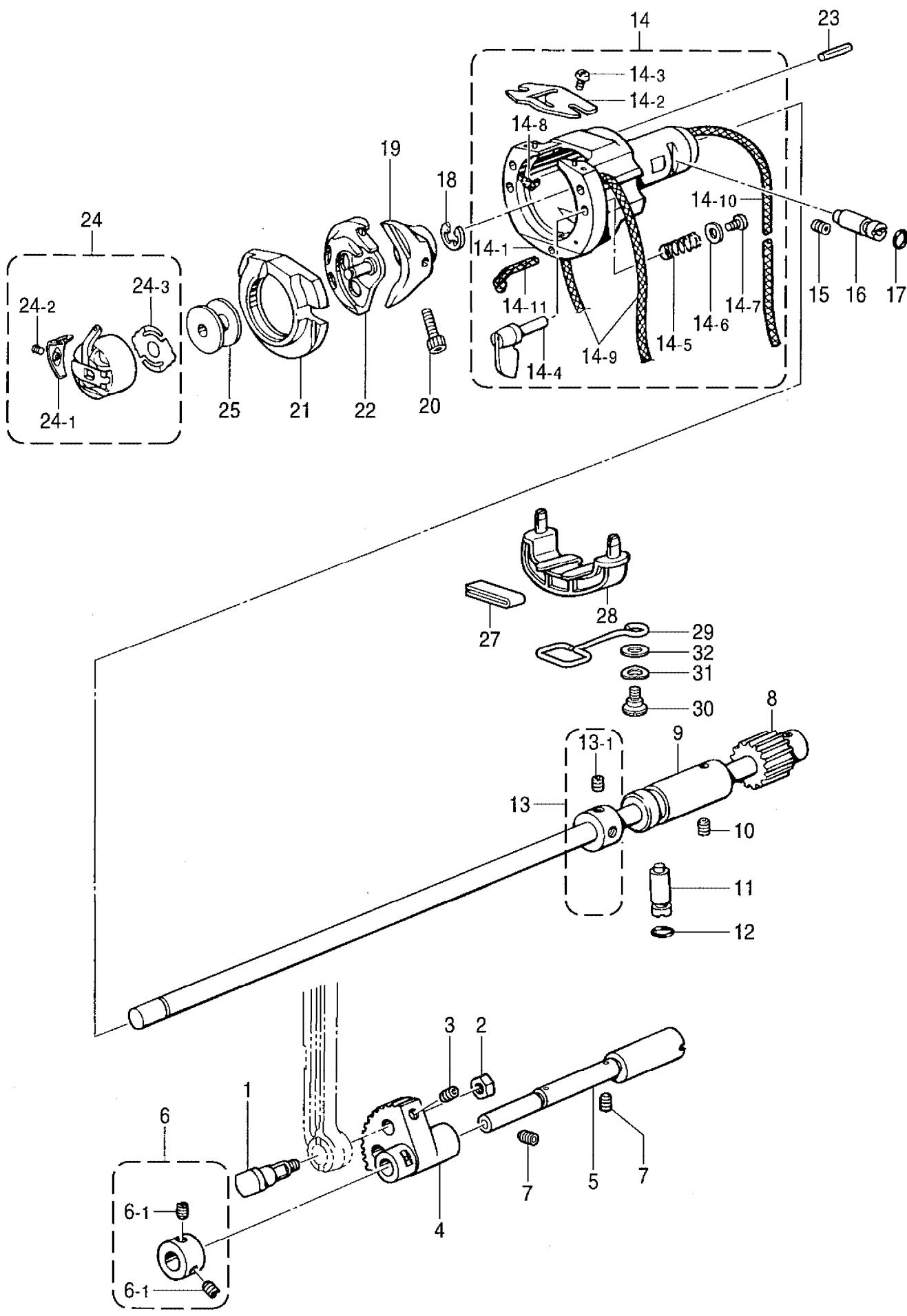
E. 下軸関係 / Lower shaft mechanism / Untere Welle / Mécanisme de l'arbre inférieur / Mecanismo del eje inferior
