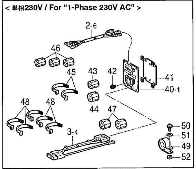
Q2. コントロールボックス関係 / Control box mechanism / Schaltkasten /
