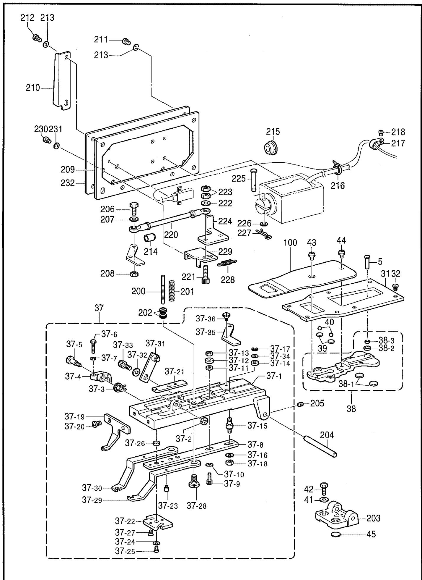
C4. 送り関係 (4320E IM) / Feed mechanism (KE-432B) / Transportvorrichtung (KE-432B) /
