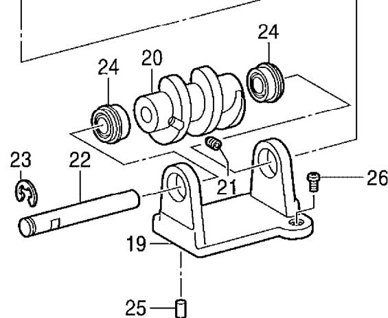
C1. 送り関係 / Feed mechanism / Transportvorrichtung / Mécanisme de l'entraînement /
