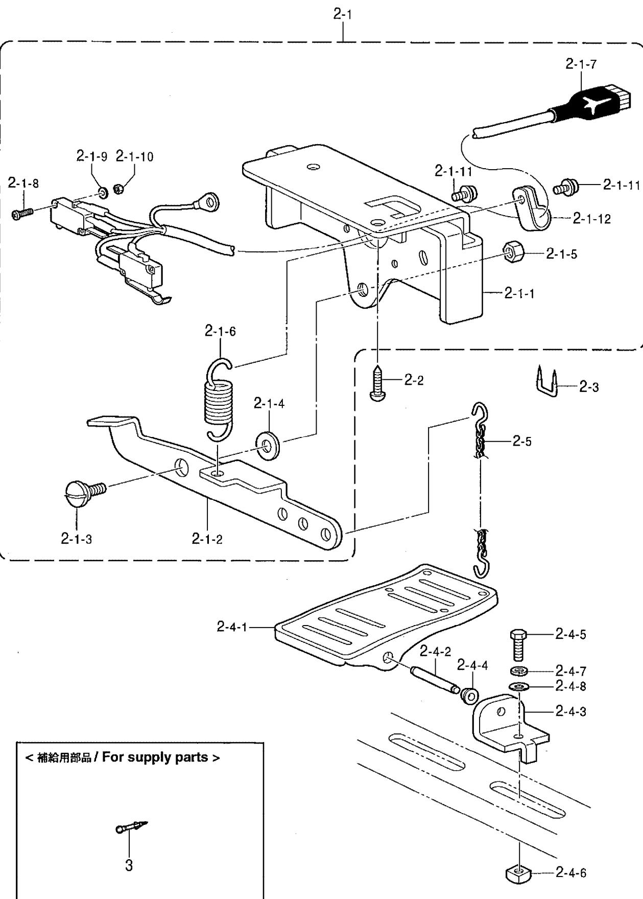
U3. 踏板関係(オプション部品) / Foot switch pedal mechanism (Option parts) / Fußbetätigung (Sonderzubehör) /
