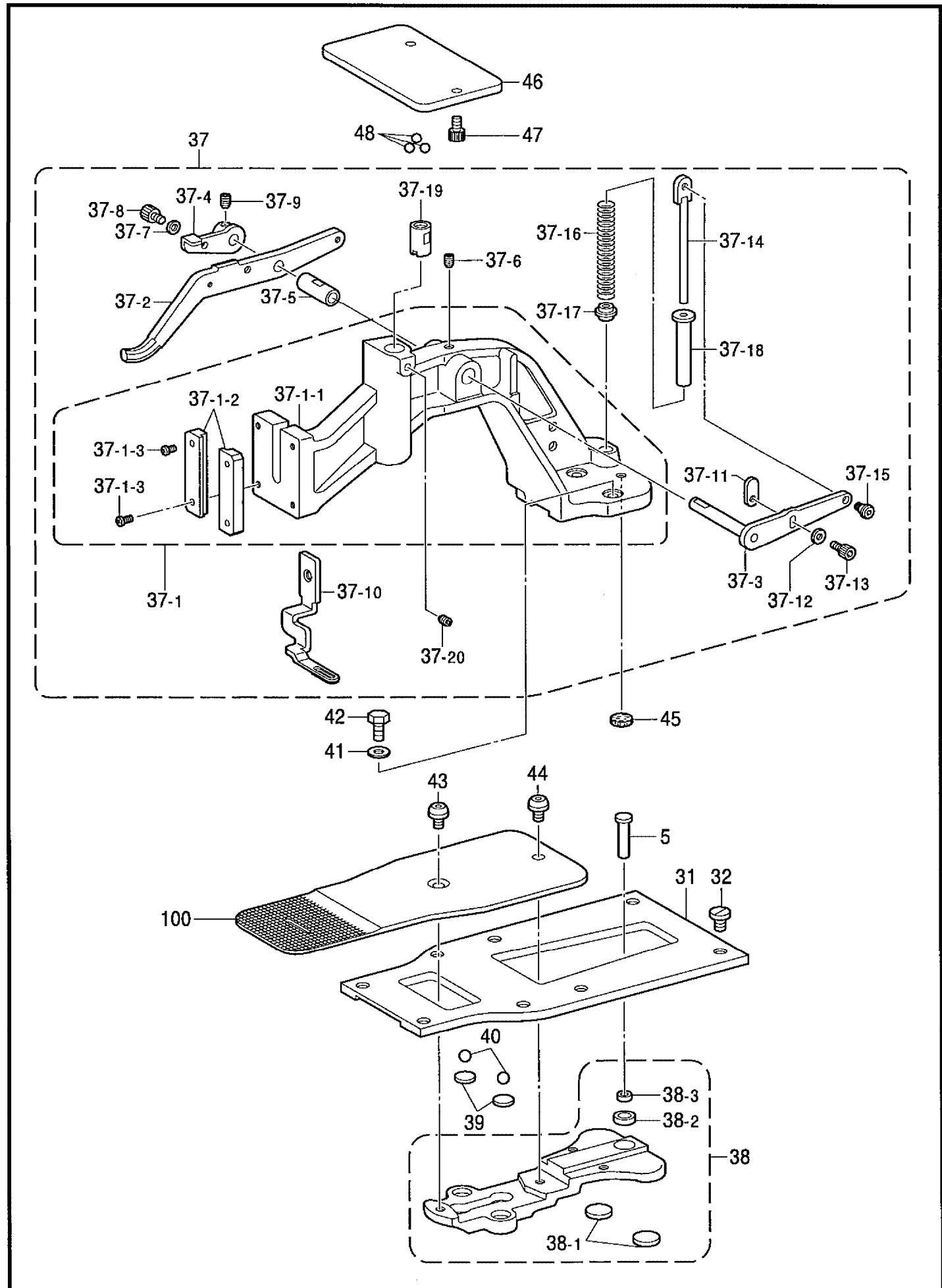
C3. 送り関係 (4310E IM) / Feed mechanism (KE-431B) / Transportvorrichtung (KE-431B) /
