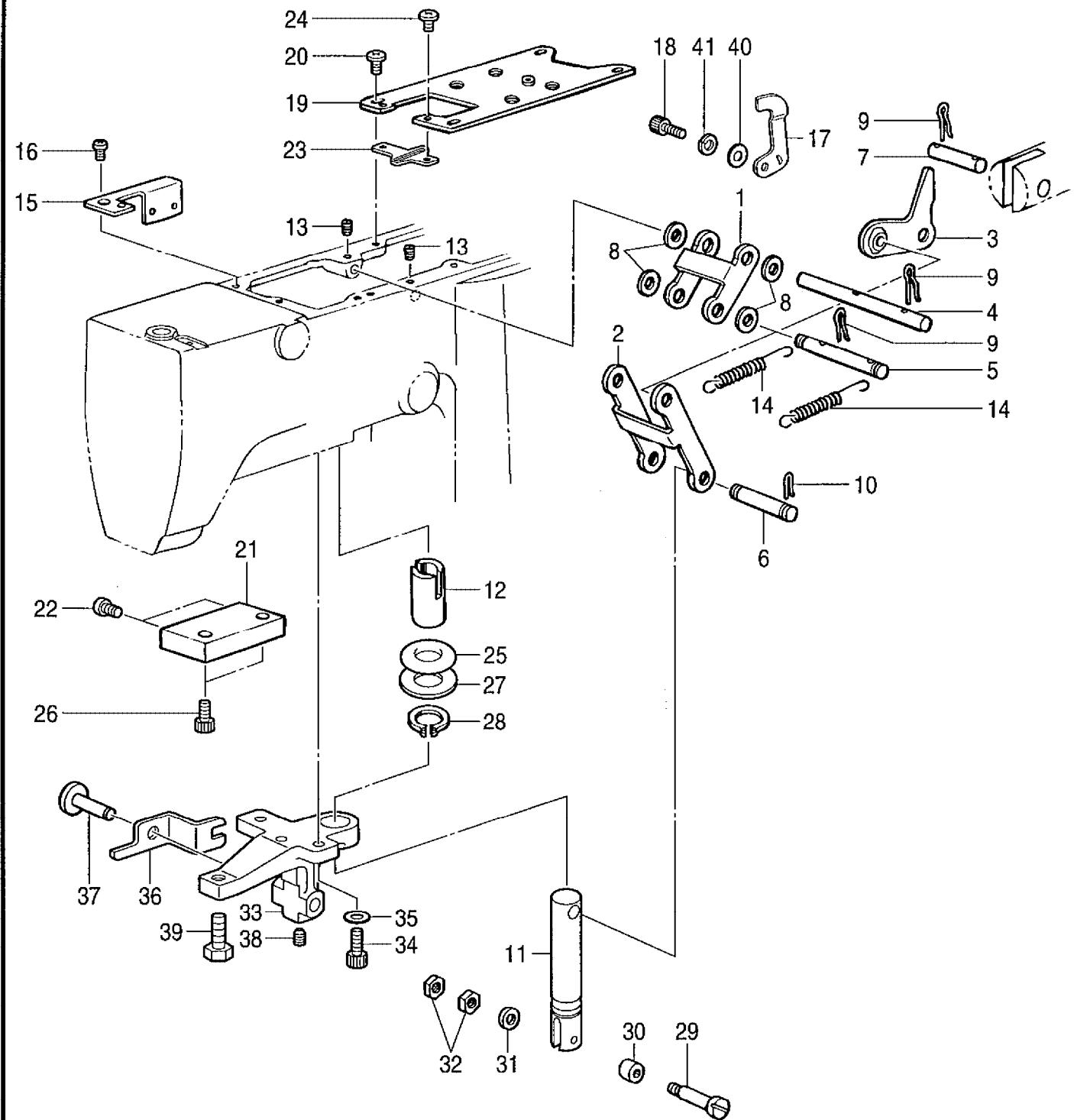
D2. 押工上ヶ関係 (4320E IM) / Work clamp lifter mechanism (KE-432B) / Stoffhalterheber (KE-432B) /
