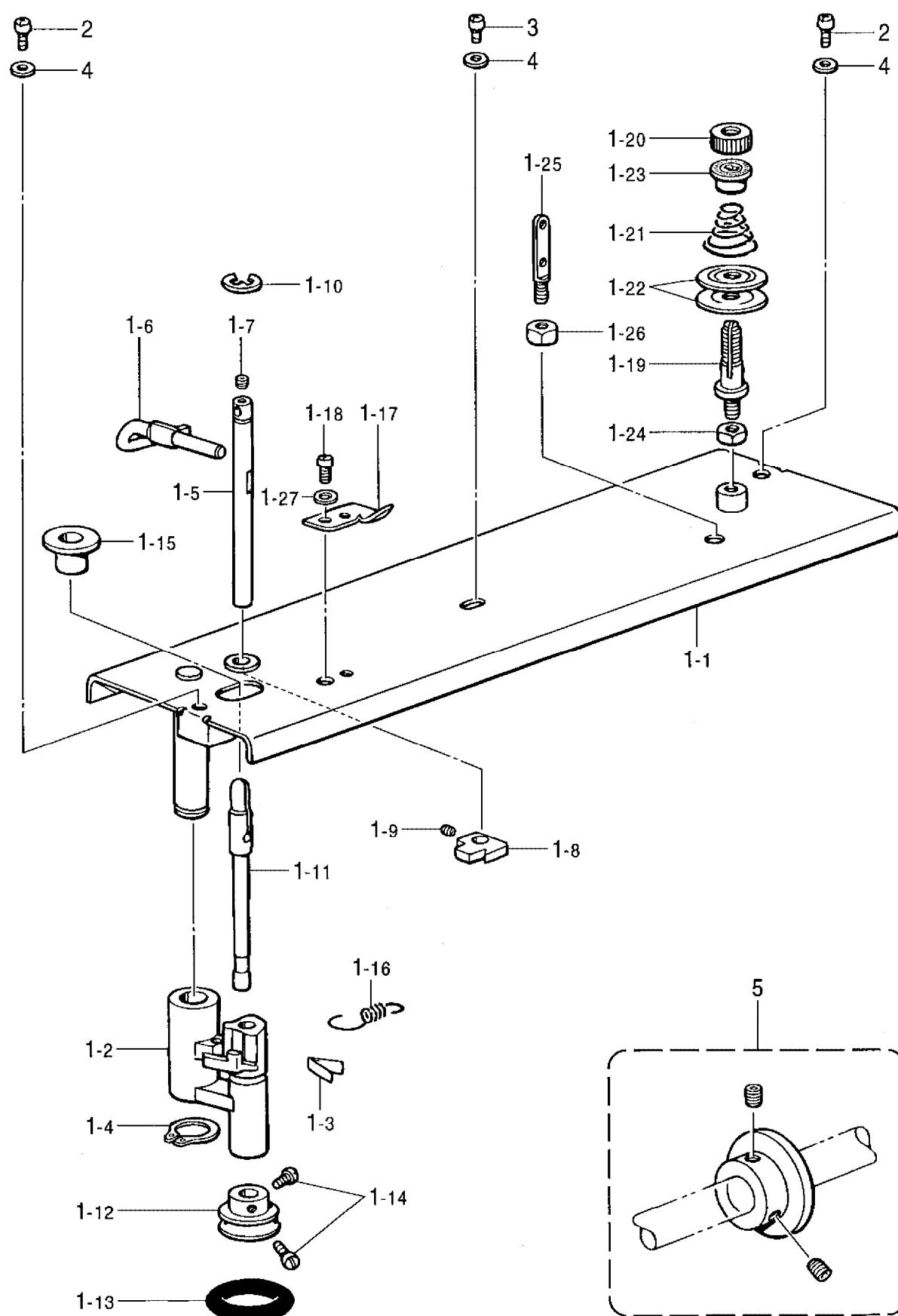
H. 糸巻関係 / Bobbin winder mechanism / Spuler / Mécanisme du bobineur /
