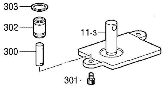
D1. 押工上部関係 / Work clamp lifter mechanism / Stoffhalterheber / Releveur de pinceur /
