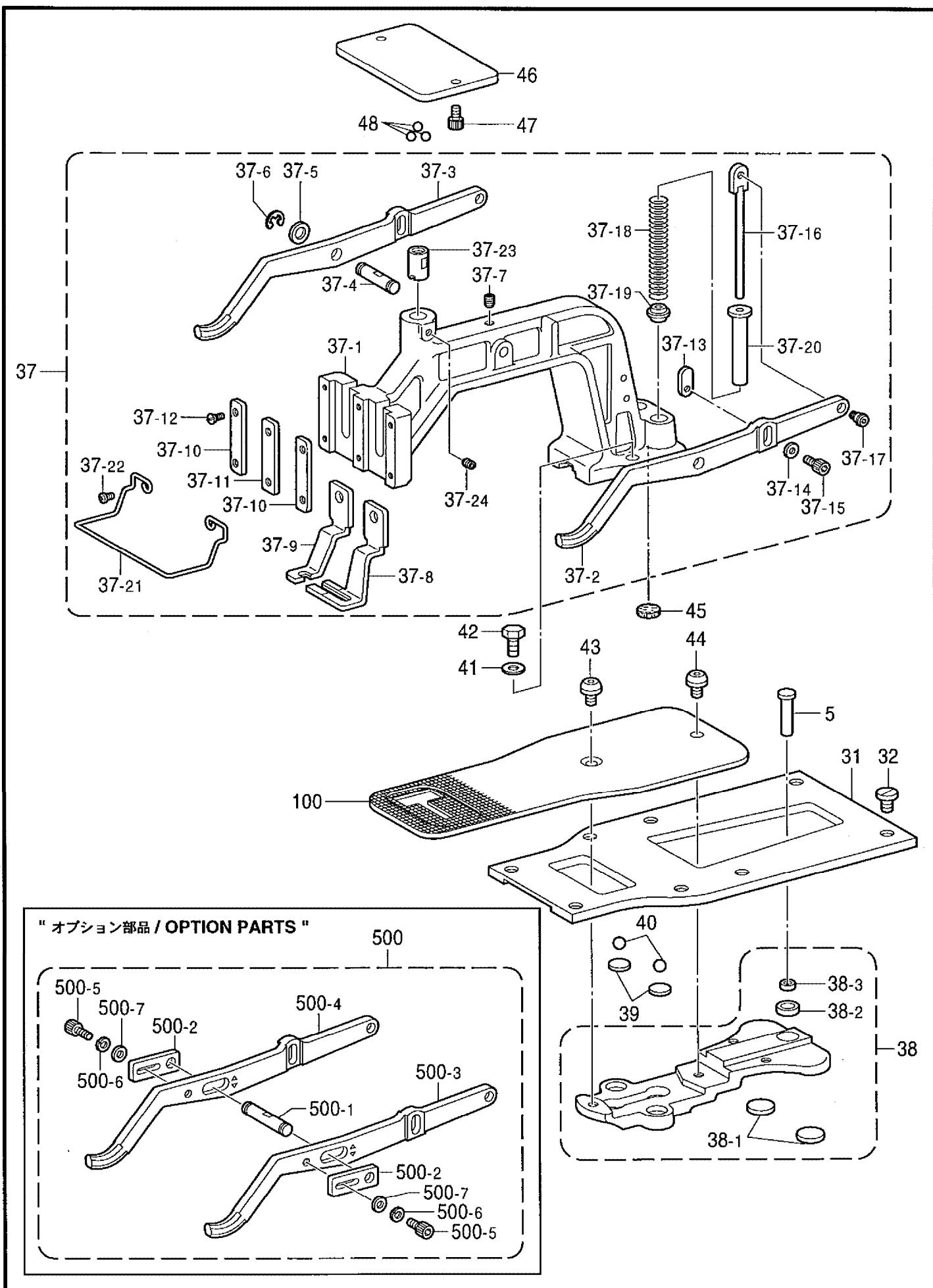
C2. 送り関係 (4300E IM) / Feed mechanism (KE-430B) / Transportvorrichtung (KE-430B) /
