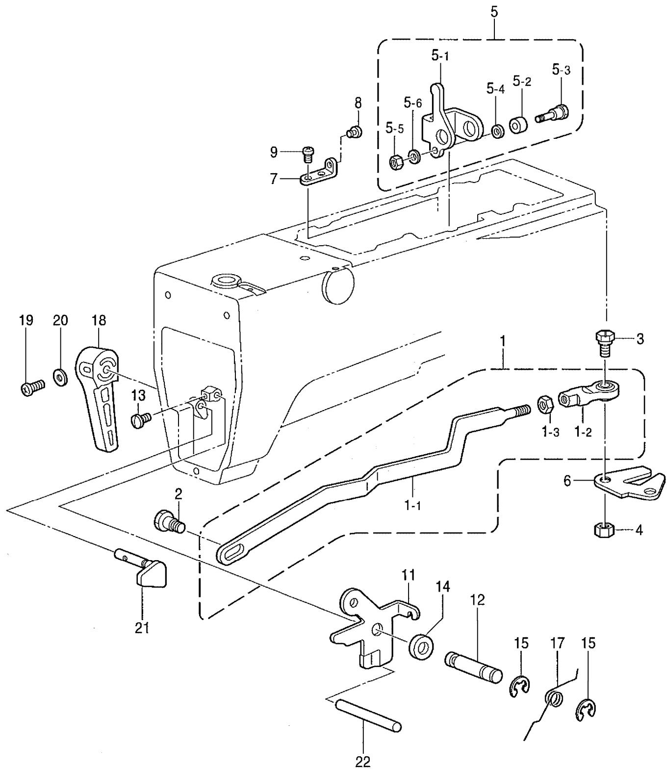
M . 糸締メ関係 / Thread nipper mechanism / Fadenspannvorrichtung / Mécanisme de pince-fil /
