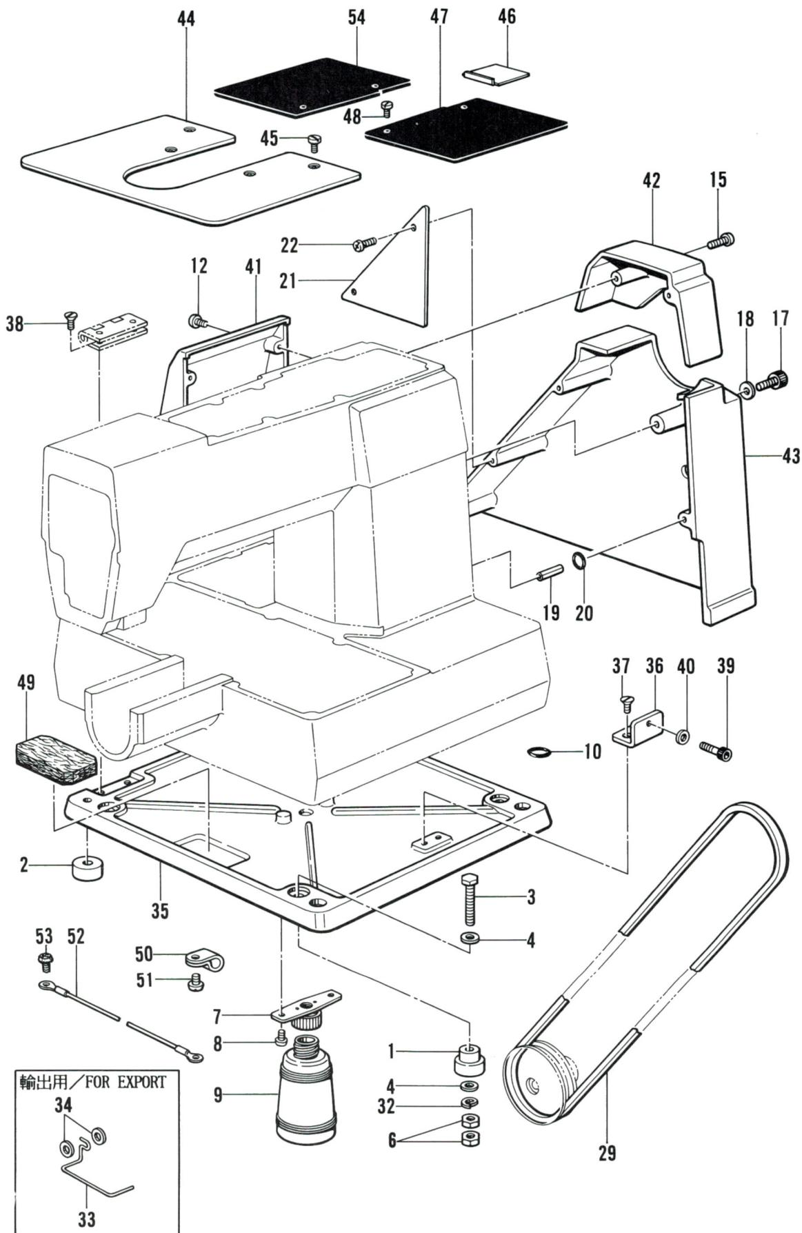
**A2. 主体関係 / Machine body/Maschinengehäuse/
