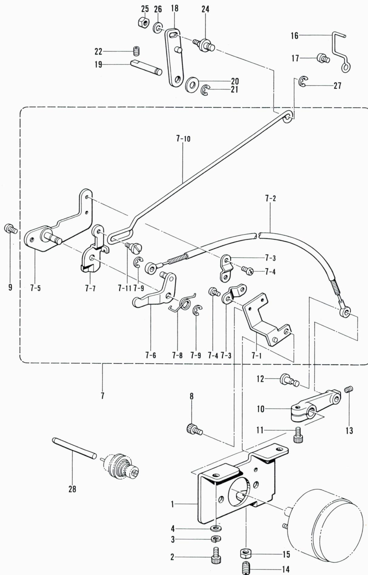
N. 糸締メ関係 / Thread nipper mechanism / Fadenspannvorrichtung /
