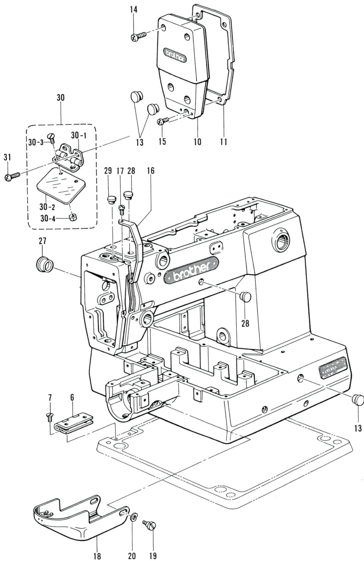
**A1. 主体関係 / Machine body/Maschinengehäuse/
