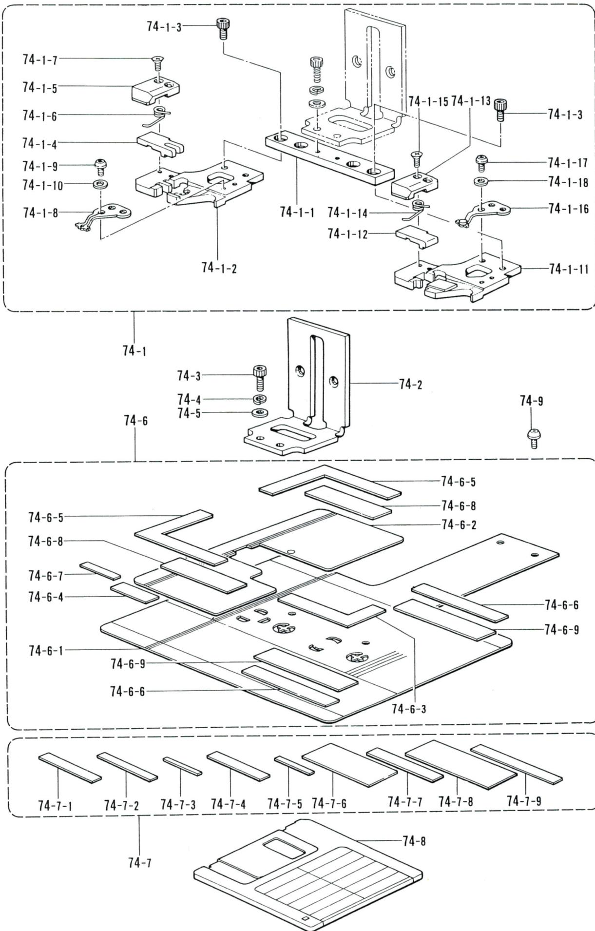
C3. 送り関係 / Feed mechanism / Transportvorrichtung /
