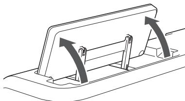
Para guardar el panel de operaciones, primero levántelo hasta que quede en posición vertical, y luego podrá bajarlo y guardarlo. Si desea disminuir el ángulo del panel de operaciones, levántelo hasta que quede en posición vertical, y luego ajuste el ángulo de nuevo.
