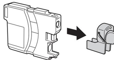
**f** Compruebe que el color de la palanca ① coincida con el color del cartucho ②, como se indica en el diagrama siguiente.
