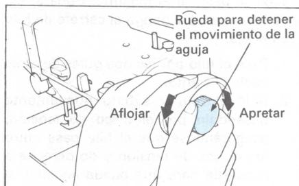
1. Sujete el volante con la mano izq. y con la derecha. gire hacia Ud. la rueda que detiene el movimiento de la aguja.
