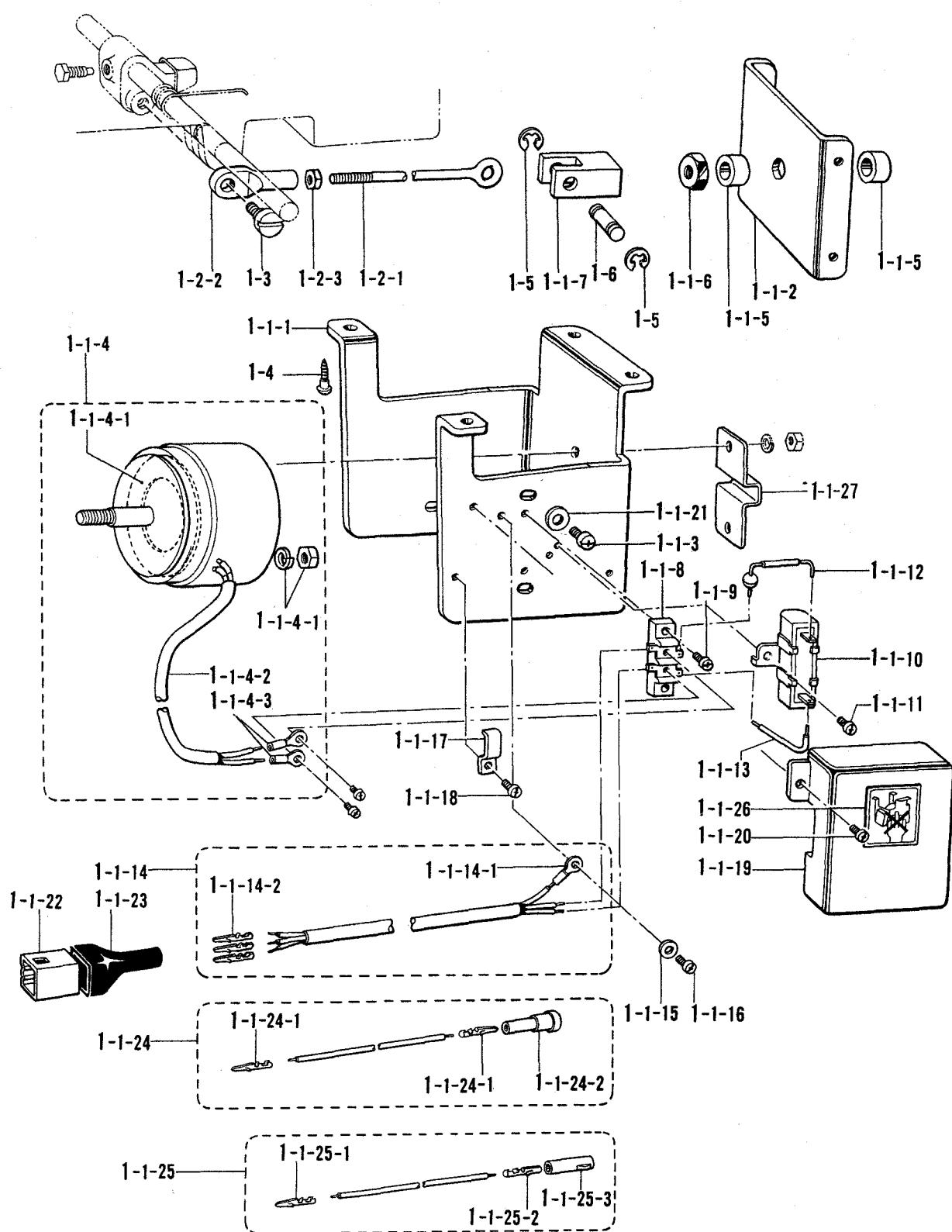
X1. 電磁押工上ゲセット /Presser foot lifting solenoid set/Solenoidsatz für die Anhebung des Stoffdrückerfußes/
