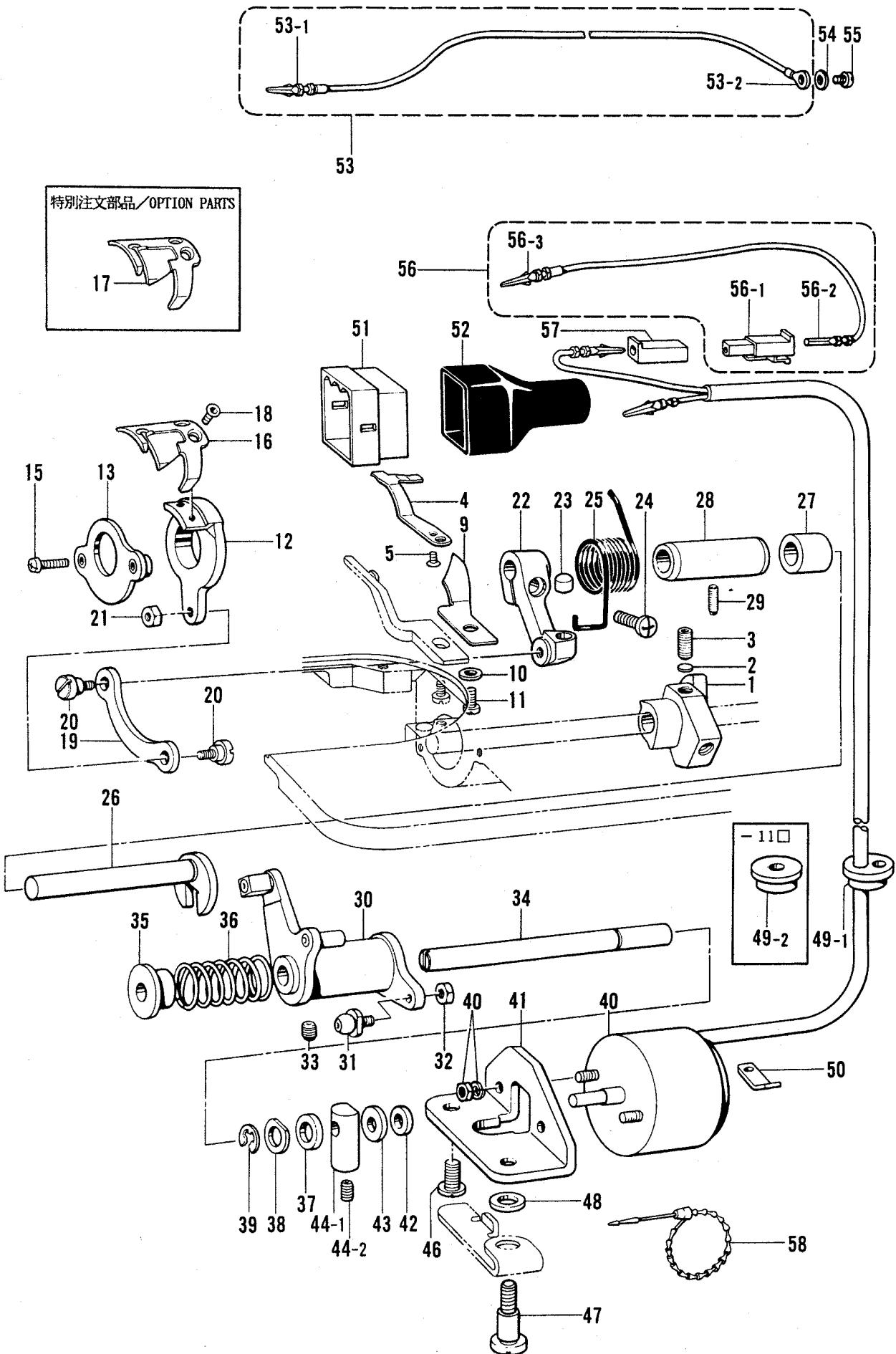
K. 糸切り関係/Thread trimmer mechanism/Fadenabschneidevorrichtung/
