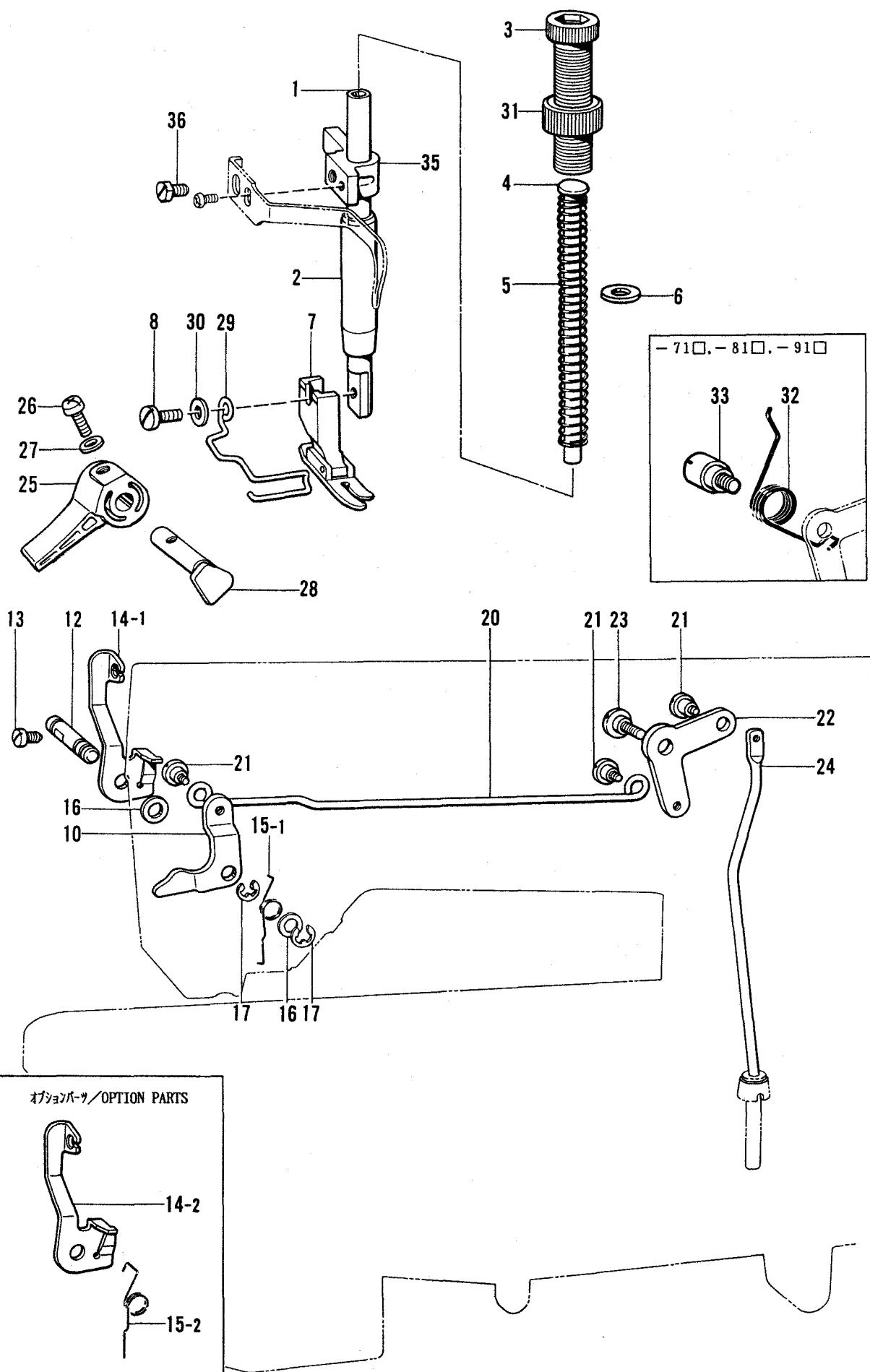
D. 押工関係/Presser foot mechanism/Stoffdrückerfuß/
