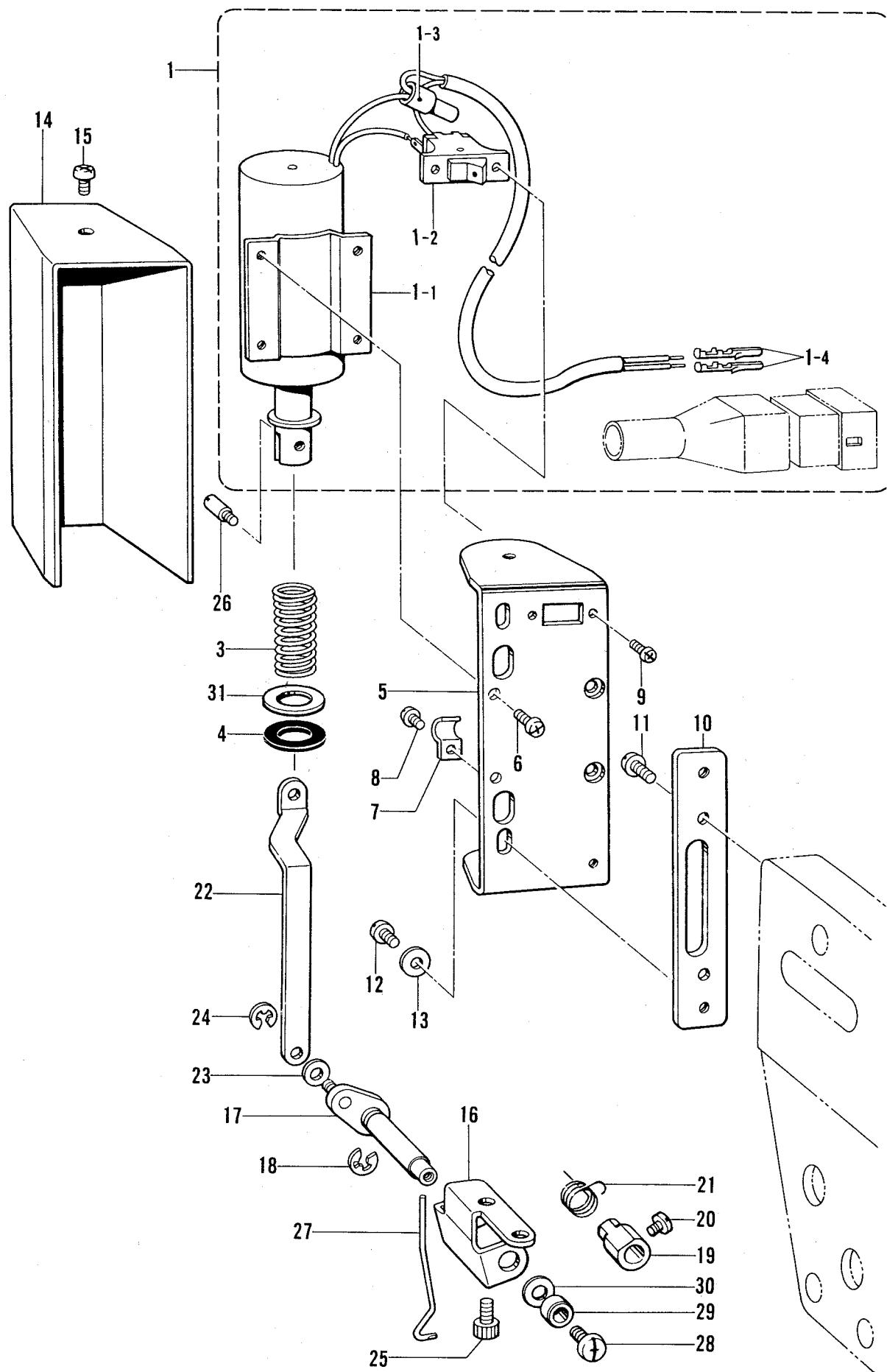
N. 糸扱イ関係/Thread wiper mechanism/Fadenwischvorrichtung/
