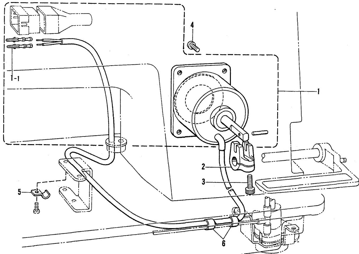
M. 糸ユルメ関係/Tension release mechanism/Spannungsverminderungsvorrichtung/
