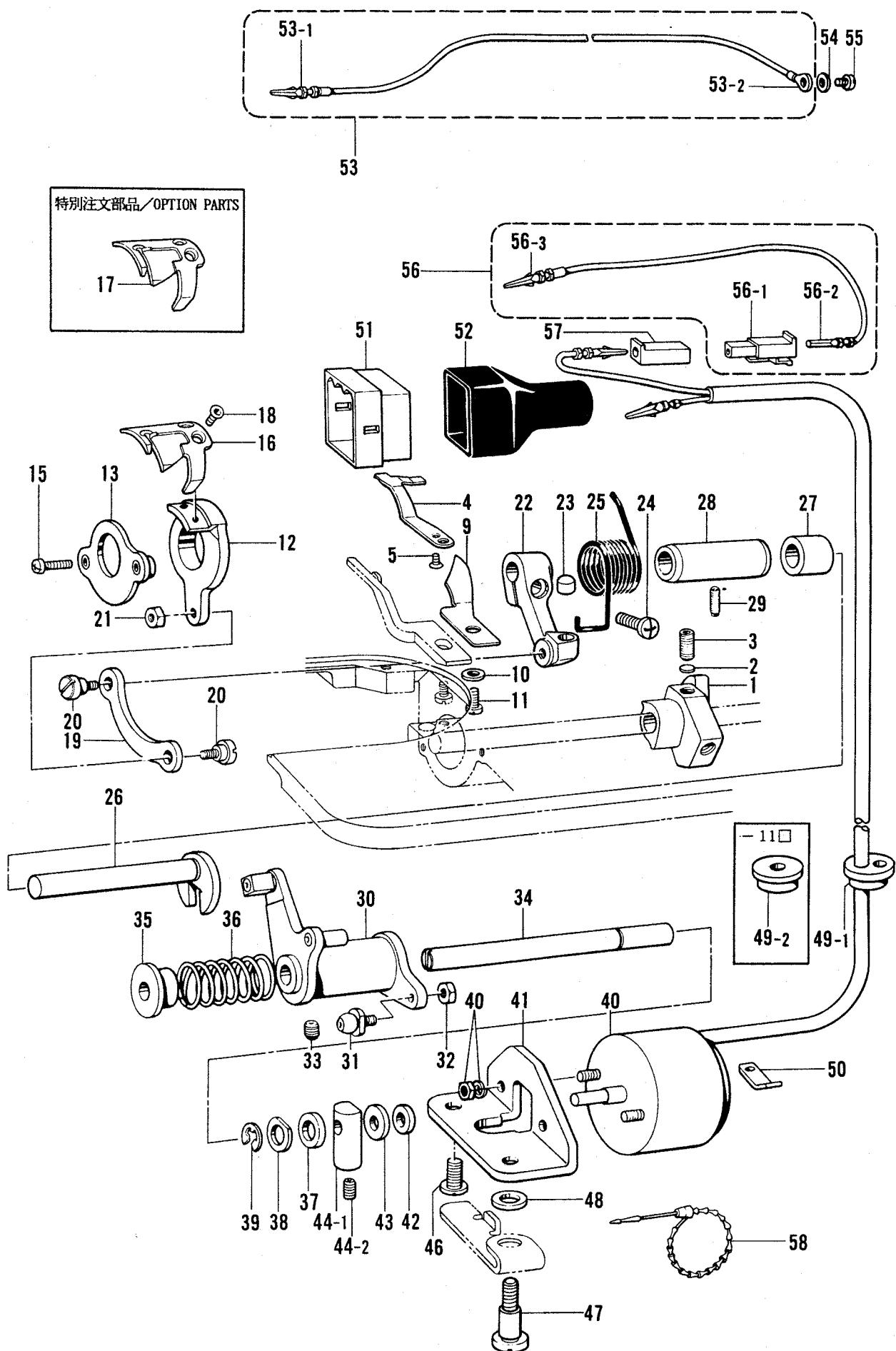
K. 糸切り関係/Thread trimmer mechanism/Fadenabschneidevorrichtung/
