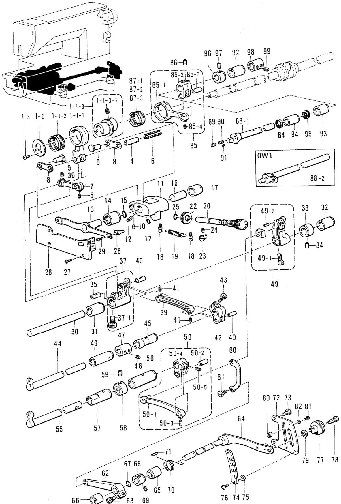
E1. 送り関係 / Feed mechanism / Transportvorrichtung /
