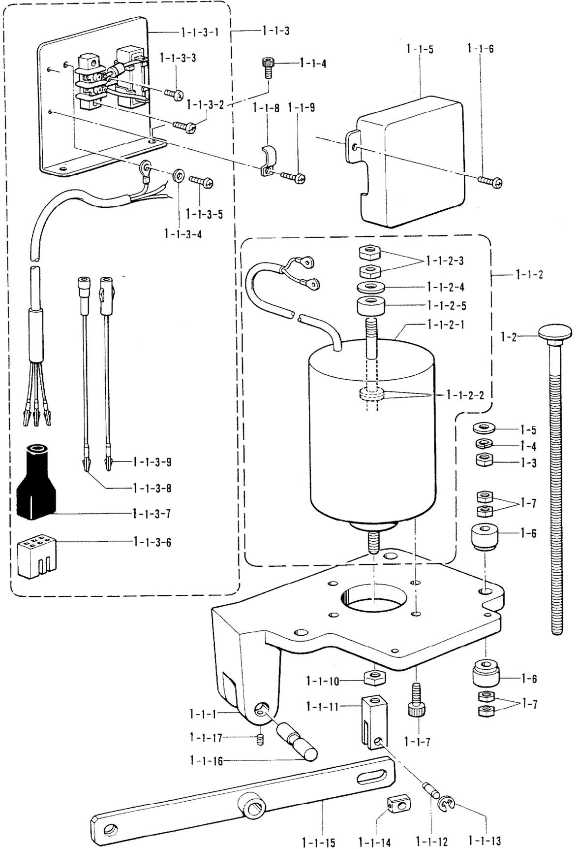
U. 電磁押工上ゲ関係 / Presser foot lifting solenoid set /
