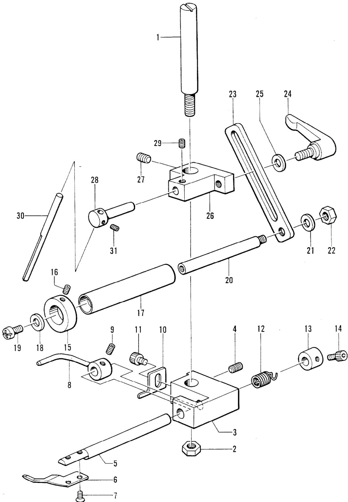
P. 縫製アタッチメント関係 / Sewing attachment mechanism / Zusatznähvorrichtung /
