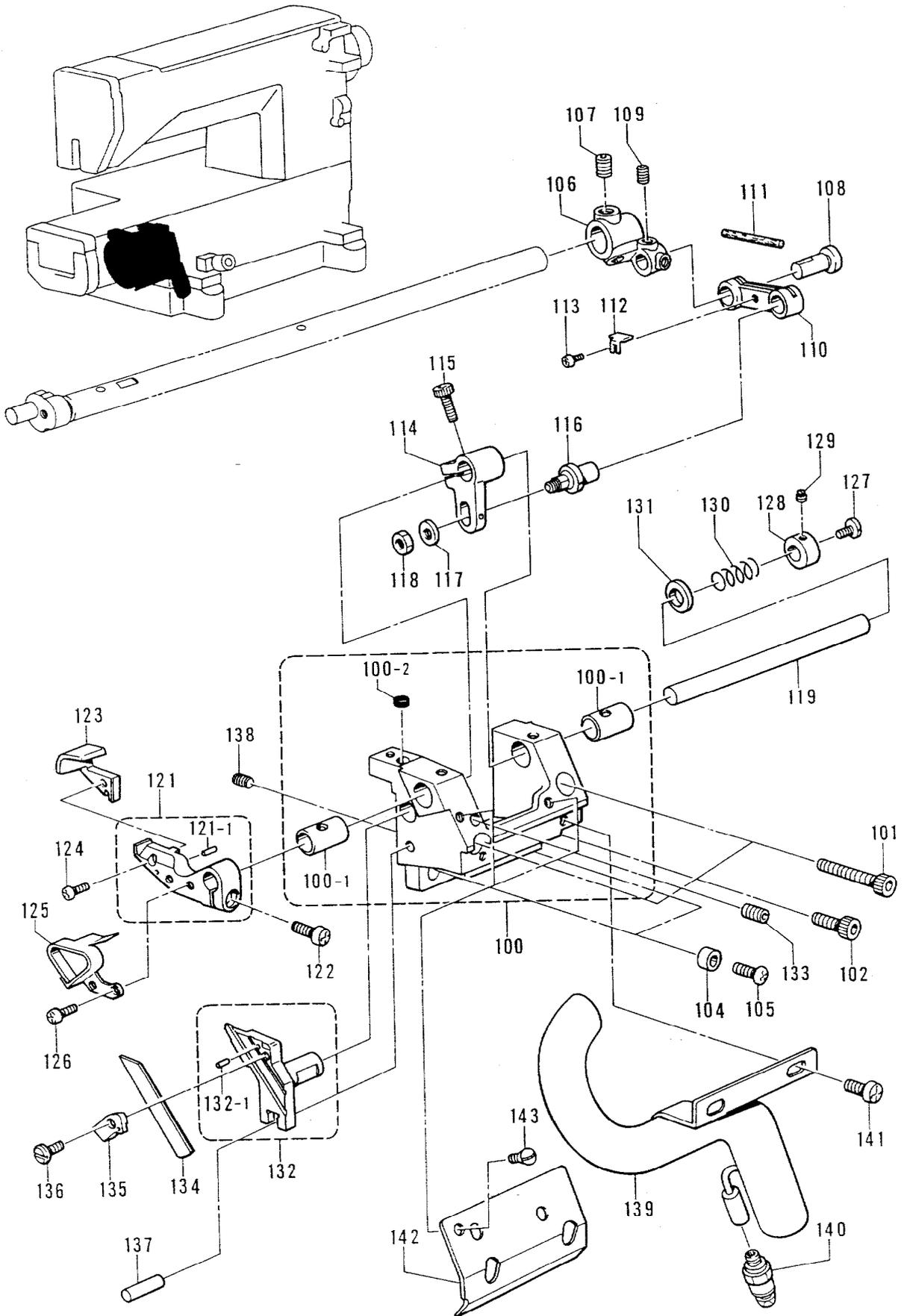
N2. トリミングメス関係 / Trimming knife mechanism / Fadenabschneidemesseinheit /
