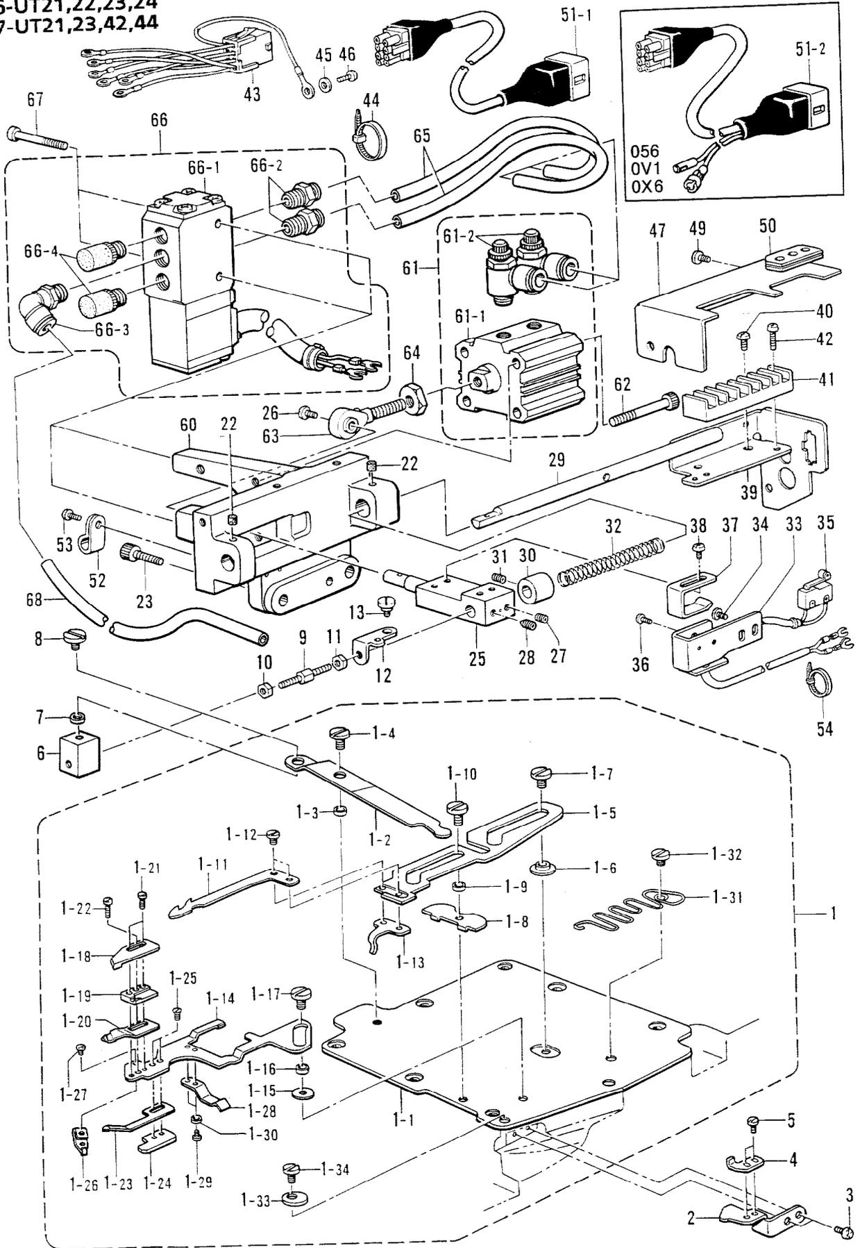
S2. 下飾り糸切り関係 / Lower thread trimmer mechanism / Unterefadensabschneider /
