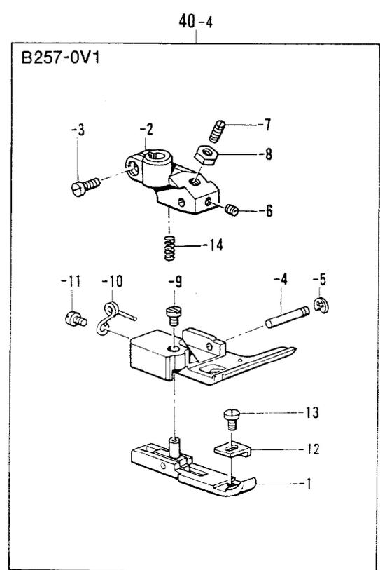
C2. 押工関係 / Presser foot mechanism / Stoffdrückerfuß /
