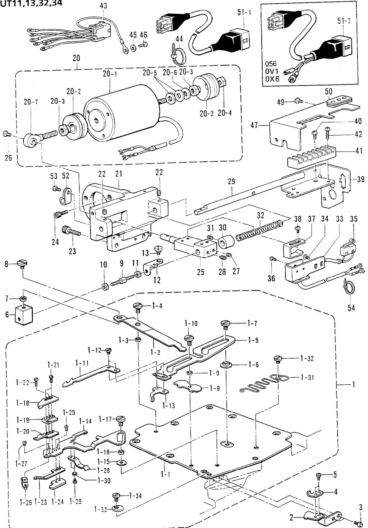
S1. 下飾り糸切り関係 / Lower thread trimmer mechanism / Unterefadensabschneider /
