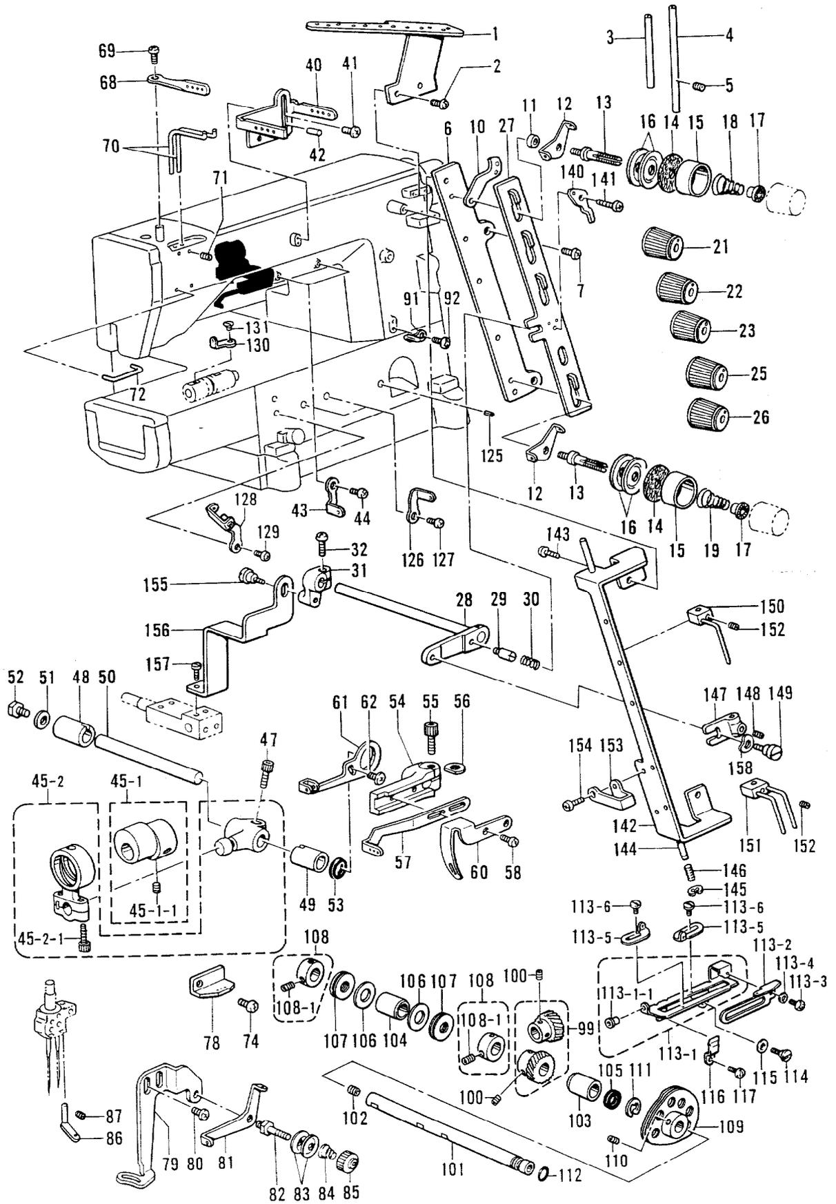
K2. 糸調子関係 / Thread tension / Faderspannung / Tension du fil / Tensión del hilo
