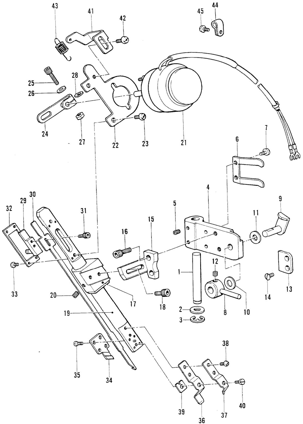
T. 上飾り糸切り関係 / Upper thread trimmer mechanism / Oberfadenabschneider /
