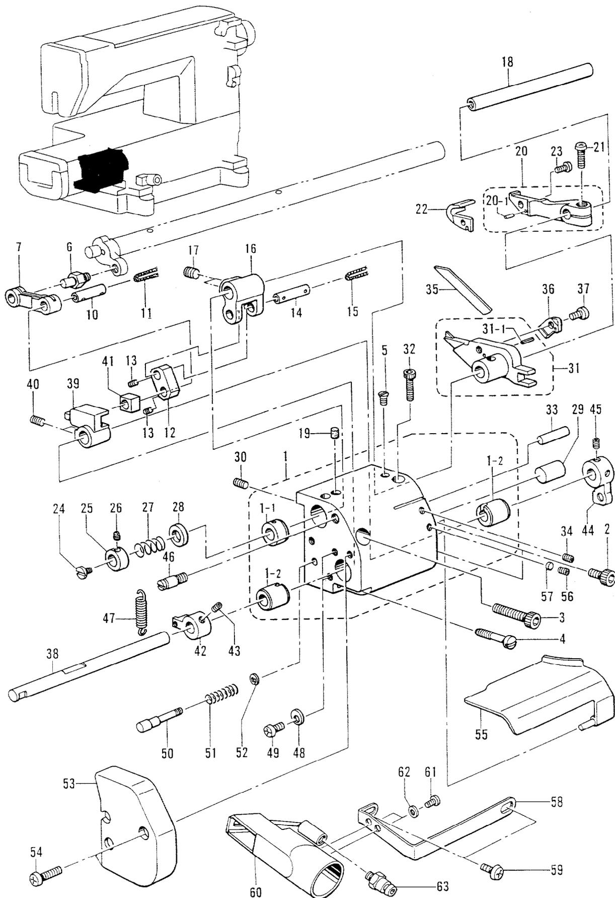
N1. トリミングメス関係 / Trimming knife mechanism / Fadenabschneidemeßereinheit /
