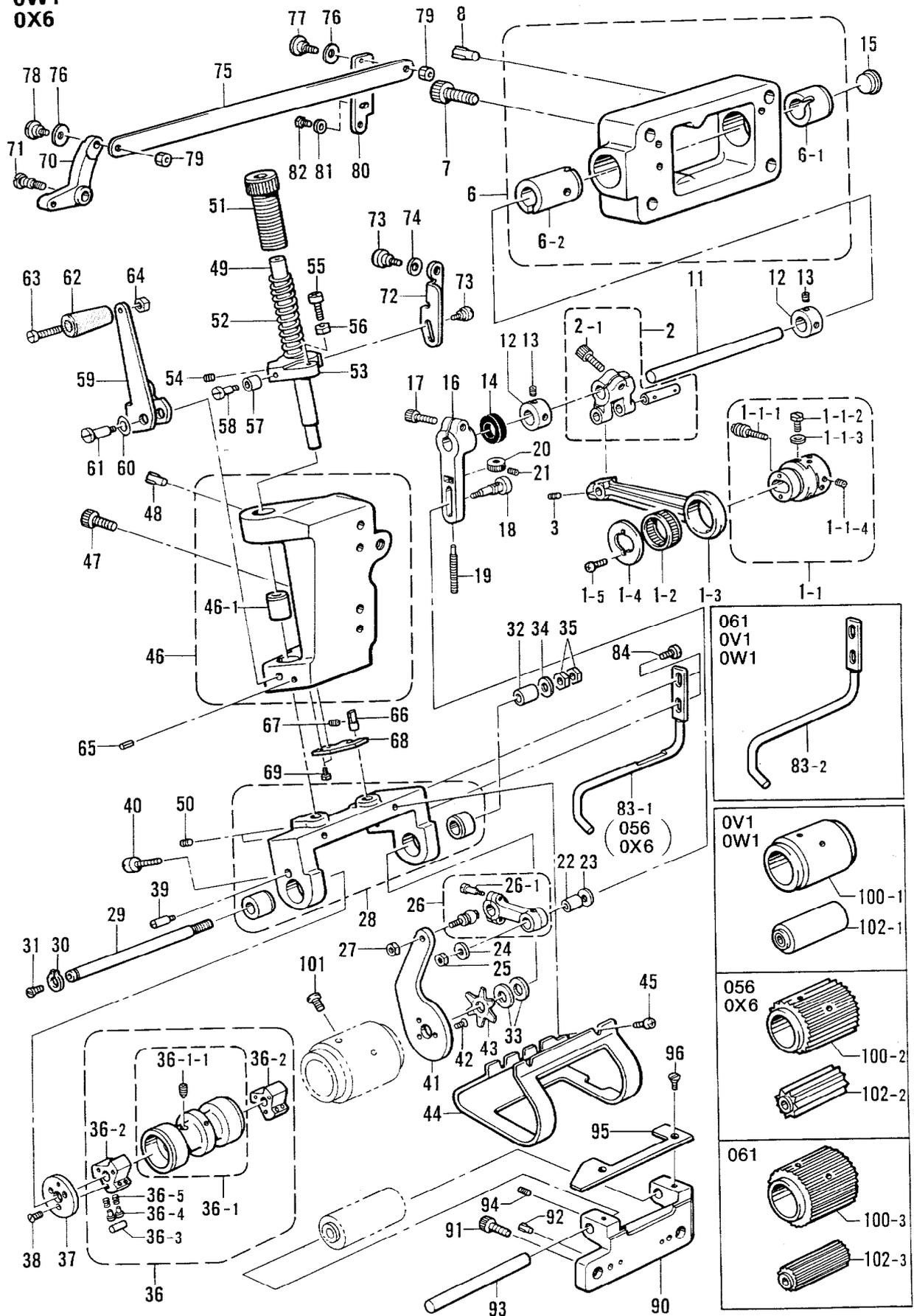
M. プーラ装置関係 / Puller device mechanism / Ziehvorrichtung /
