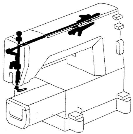
C1. 押工関係 / Presser foot mechanism / Stoffdrückerfuß /
