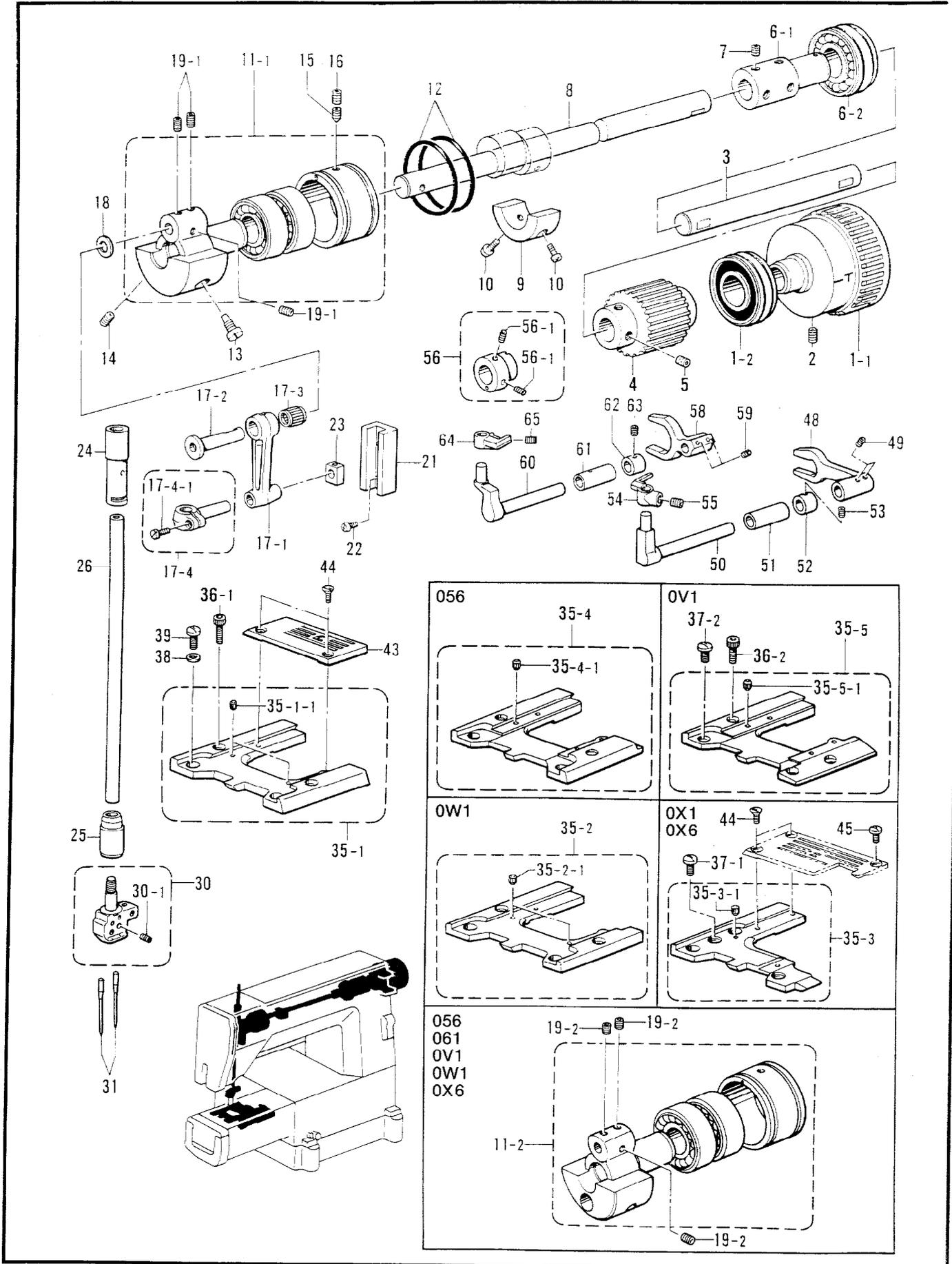
B. 上軸・針棒関係 / Upper shaft and needle bar mechanism / Obere Welle und Nadelstangenvorrichtung / Mécanisme de arbre supérieur et barra à aiguille / Mecanismo del eje superior y la barra de aguja
