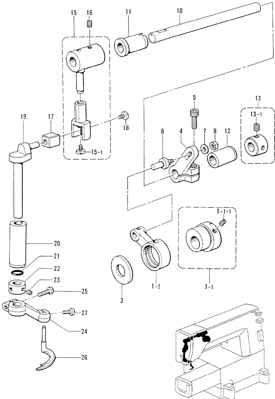
J. スプレダー関係 / Spreader mechanism / Spreizvorrichtung /
