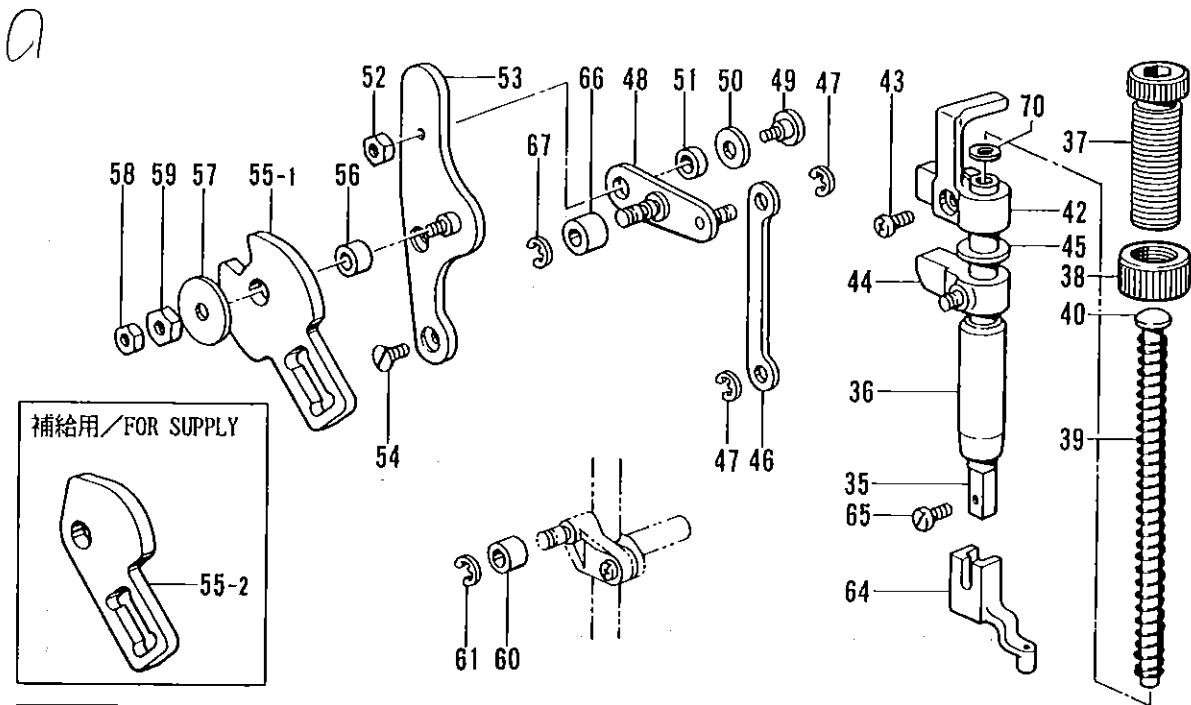
電磁、スナップ・ホックツケヨウ /SOLENOID, SNAP AND HOOK TYPE
