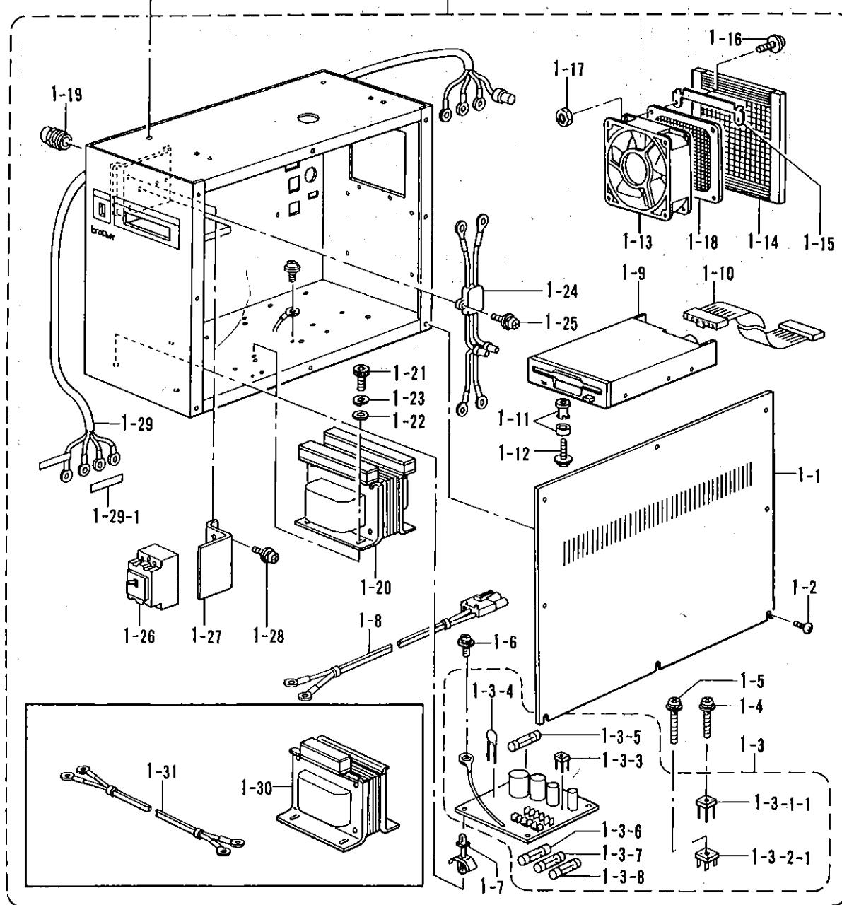
R. コントロールボックス関係 /Control box mechanism/Stromversorgung/
