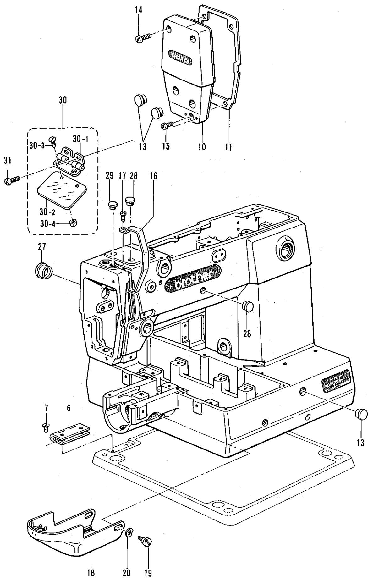
A. 主体関係 /Machine body/Maschinengehäuse/
