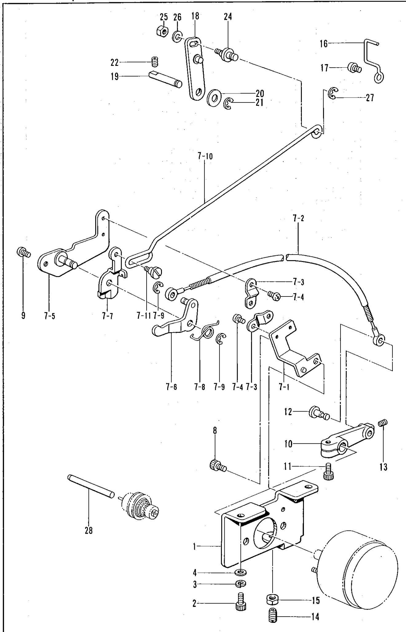
P. 糸締メ関係/Thread nipper mechanism/Fadenspannvorrichtung/
