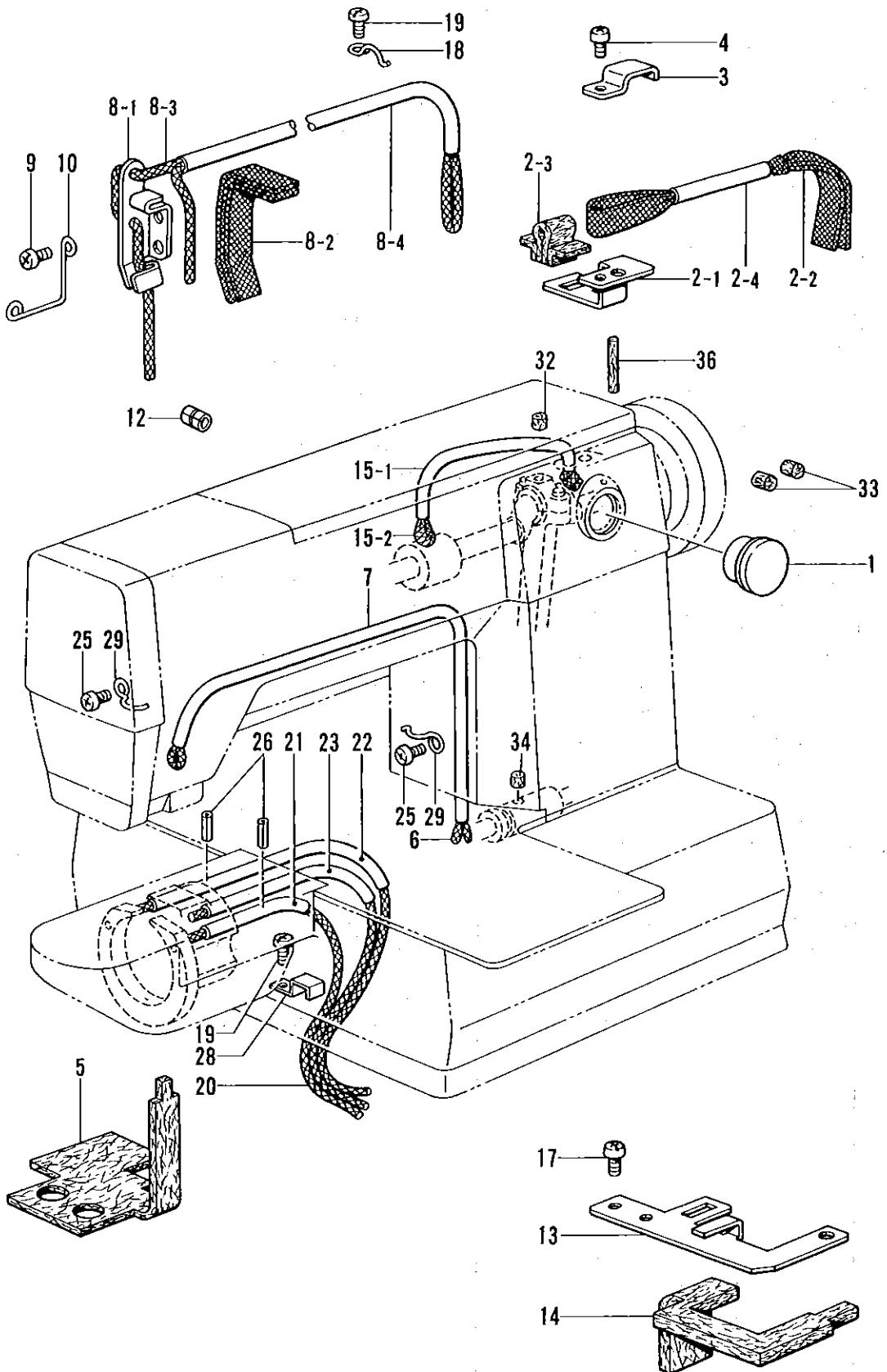
H. 給油・潤滑関係/Lubrication/Schmierung/
