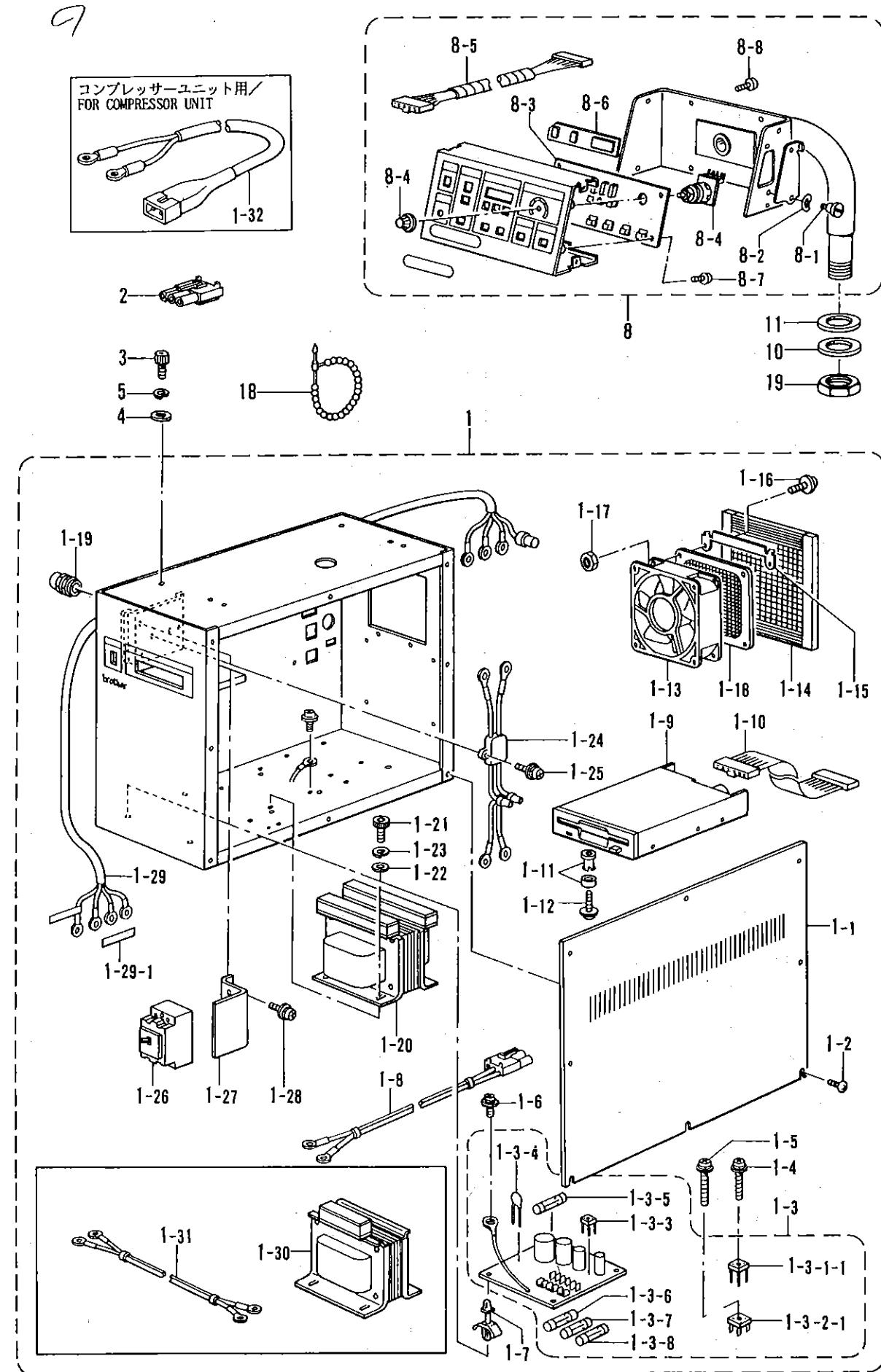
R. コントロールボックス関係 / Control box mechanism / Stromversorgung /
