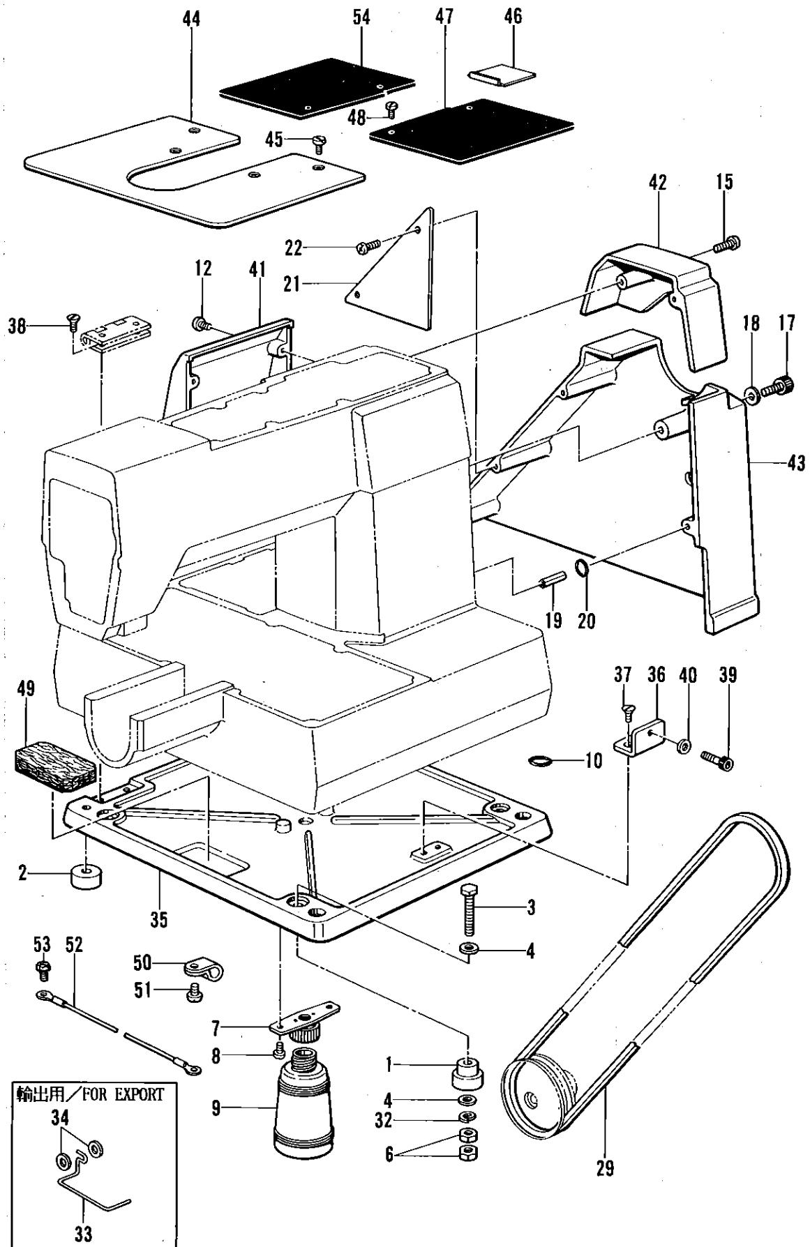
B. 主体関係 /Machine body/Maschinengehäuse/
