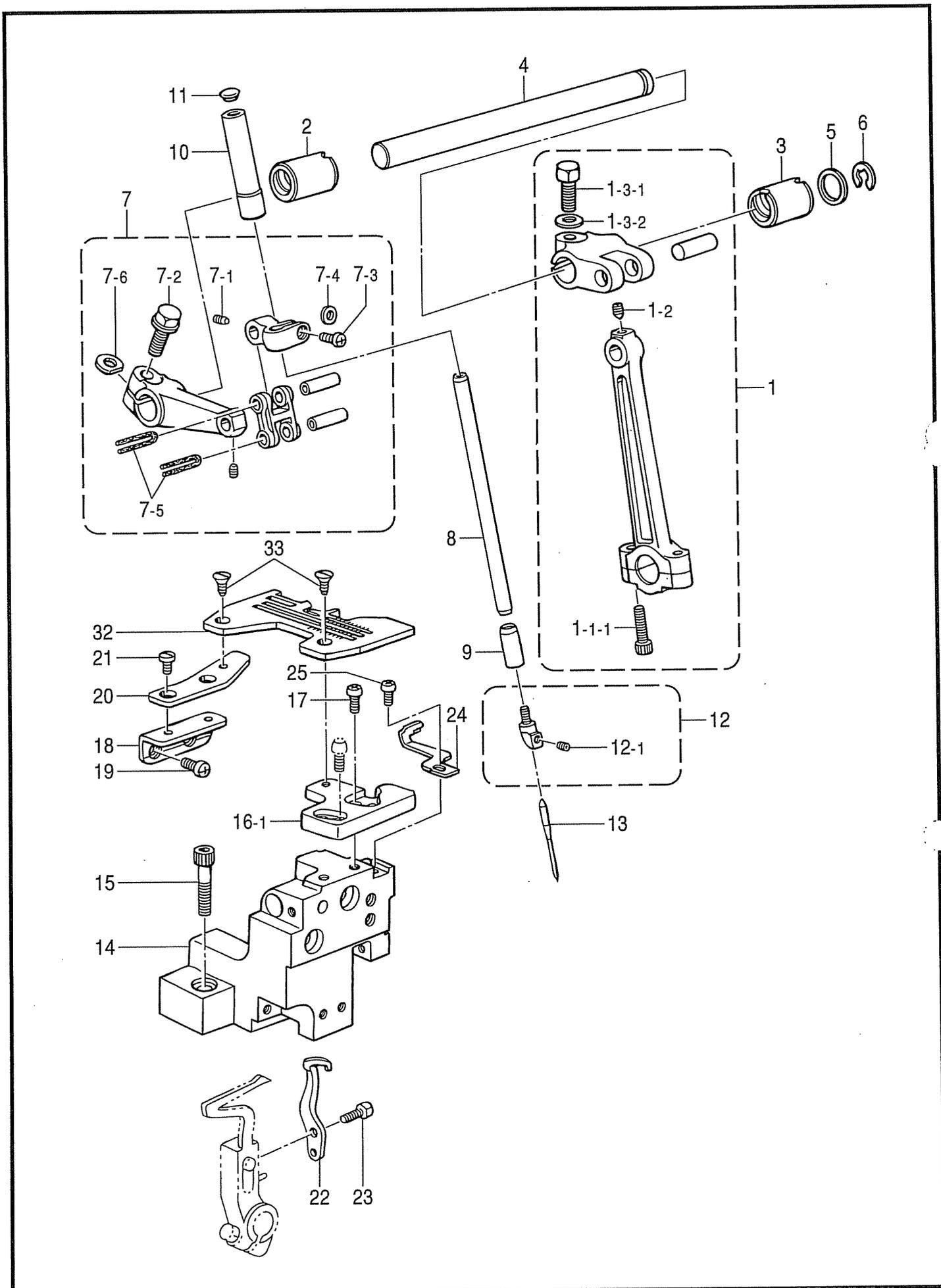
C. 針棒関係 / Needle bar mechanism
