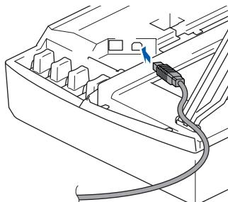
**10** Faites passer soigneusement le câble USB à travers la tranchée et en dehors de l'arrière de l'appareil, comme illustré ci-dessous.
