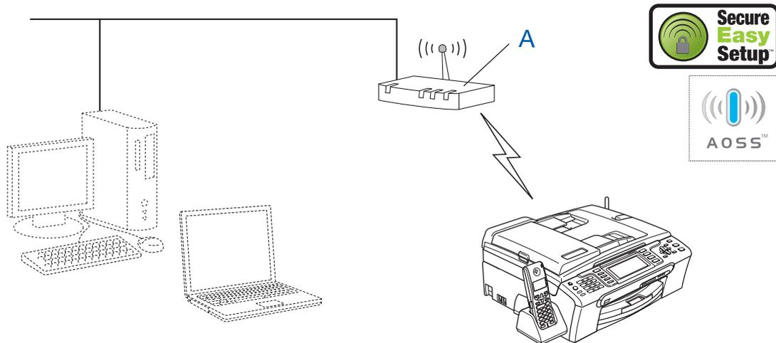
Si votre point d'accès sans fil (A) prend en charge SecureEasySetup™ ou AOSS™, vous n'avez pas besoin d'utiliser un ordinateur pour configurer l'appareil. Le point d'accès (routeur) et votre appareil peuvent négocier automatiquement en utilisant la procédure de SecureEasySetup™ ou d'AOSS™.
