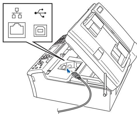
**4** Acheminez avec soin le câble de réseau dans la fente prévue à cet effet en le faisant ressortir par l'arrière de l'appareil. Ensuite, connectez le câble à votre réseau.
