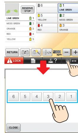
Berühren Sie die Taste für die Nadelstange, in die der Faden eingefädeln werden soll.
