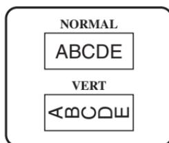
Après avoir sélectionné le mode du Format d'étiquette **NORMAL** ou **VERT**, le texte de l'étiquette peut être saisi, mis en page, imprimé et coupé normalement. Si le mode sélectionné est **Normal**, le texte saisi s'imprime horizontalement sur l'étiquette. Si le mode sélectionné est **Vertical**, le texte saisi s'imprime verticalement sur l'étiquette.
