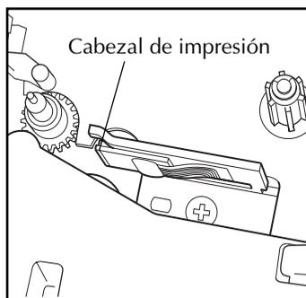
☞ *El cabezal de impresión se podrá limpiar más fácilmente empleando el casete de limpieza de cabezales de impresión opcional (TZ-CL4).*
