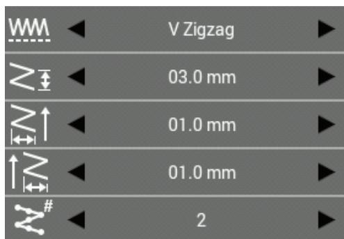
5. Ajuste la longitud de costura continua y el ancho de zigzag para las puntadas de zigzag tipo V.
