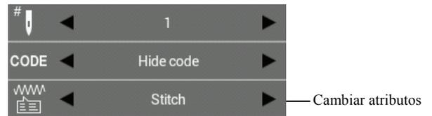
\* Cuando se cambia de "Alimentación" a "Puntada" o de "Hilván" a "Puntada", la longitud de costura debe ser de 12,7 mm o menos para X e Y. Si el ajuste está fuera de rango, el zumbador sonará dos veces y el procesamiento se detendrá.
