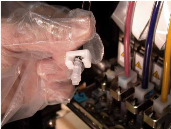
(14) Gire la palanca en la dirección de la flecha para desbloquear la cabeza de impresión.
