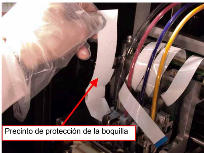
(20) Qúitese los guantes, inserte el cable plano en el conector y, a continuación, doble la conexión para bloquear el cable.
