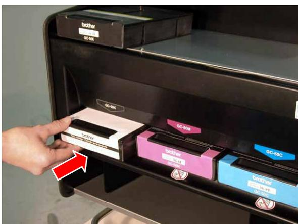
Empezará a vaciarse la tinta de la cabeza. Espere hasta que aparezca el mensaje "apagar y cambiar cabeza[X]"
