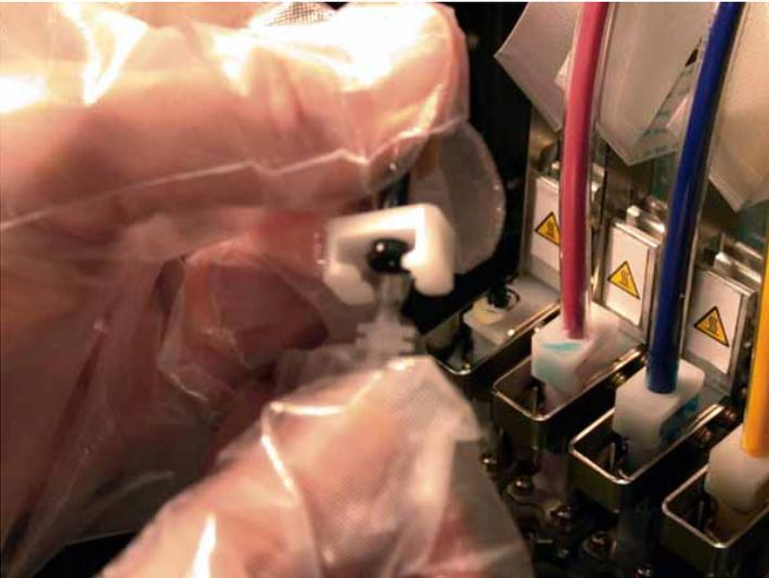
(22) Inserte el tubo en la nueva cabeza de impresión y gire el conector del tubo 90 grados en la dirección de la flecha.
