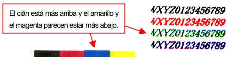
(33) Si la calidad es buena, pase a la siguiente sección, "7-2-8. Ajuste después de la sustitución de la cabeza de impresión", para completar el ajuste después de la sustitución de la cabeza de impresión.
