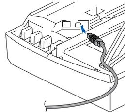
3. Faites passer soigneusement le câble USB à travers la tranchée et en dehors de l'arrière de l'appareil comme illustré ci-dessous.
