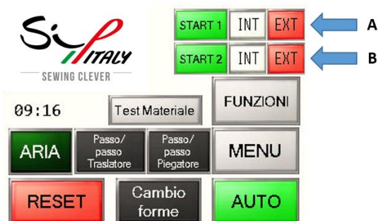
Figura 9 - Pannello operatore SIP: schermata home
