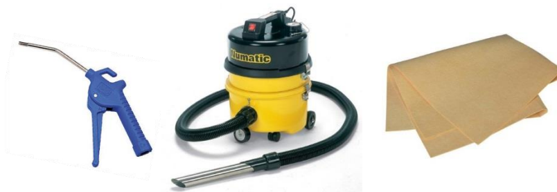
Figura 8 - Strumenti idonei alla pulizia della macchina
